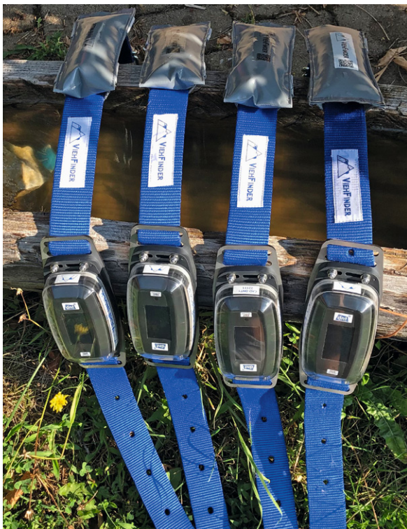
Bild 5: GPS-Tracker zur Ortung von Weidevieh mit Halsgurt und Gegengewicht
