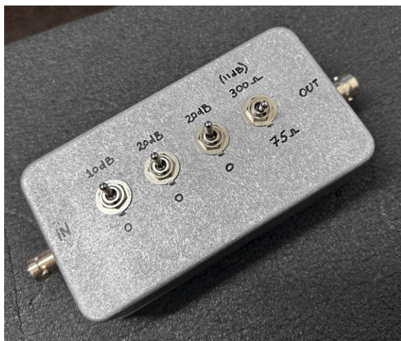
Bild 9: Ein geschaltetes Dämpfungsglied im Eigenbau und ein L-Pad zur Impedanzanpassung
