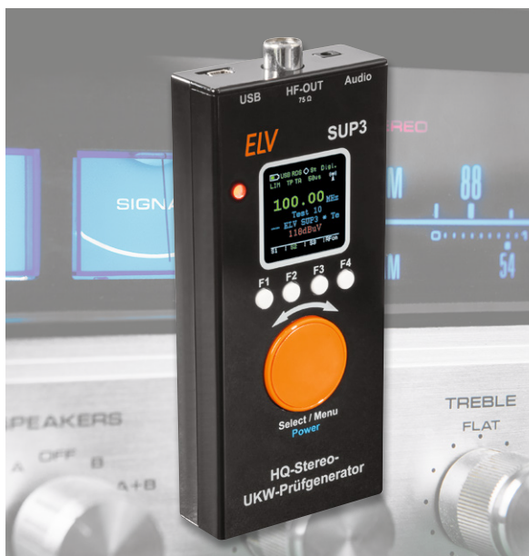
Bild 2: Der Hochfrequenz-Signalgenerator ELV SUP3
