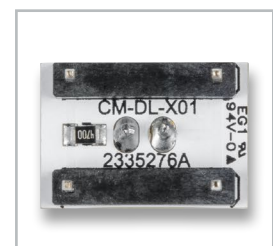
Bild 26. Der Vorwiderstand (470 \Omega ) ist bei der LED-Platine integriert.
