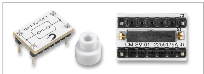
Bild 12: Reed-Kontakt mit Testmagnet
