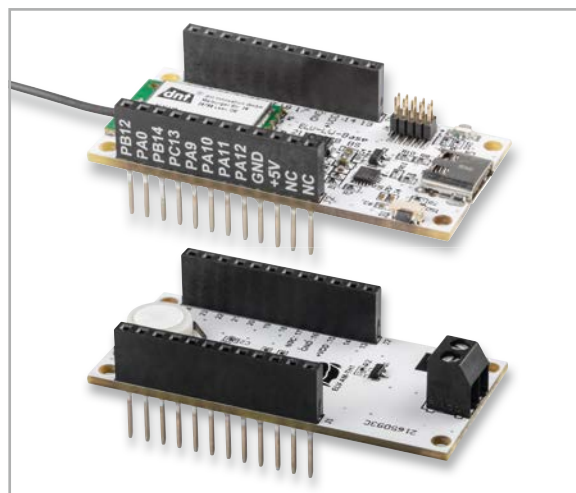
Bild 1: Hardwarekomponenten für die Integration von LoRaWAN® in Home Assistant (ELV-LW-Base und Applikationsmodul ELV-AM-TH1)
