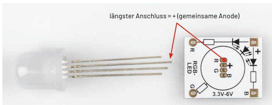
Bild 32: Bei der RGB-LED ist Polung durch unterschiedliche Längen der Anschlussdrähte erkennbar.
