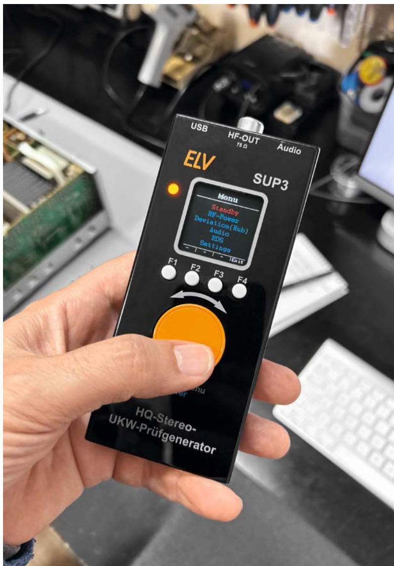
Bild 5: Das Drehgeber-Menüsystem ist einfach zu bedienen, auch mit nur einer Hand.
