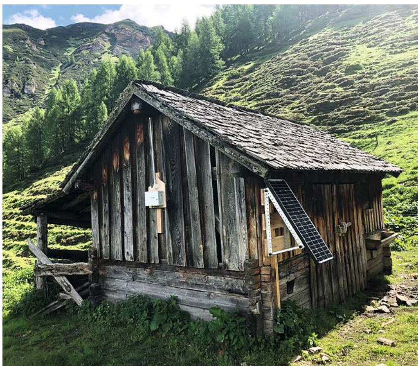
Bild 7: Per Solarzelle und Akku versorgtes Gateway
