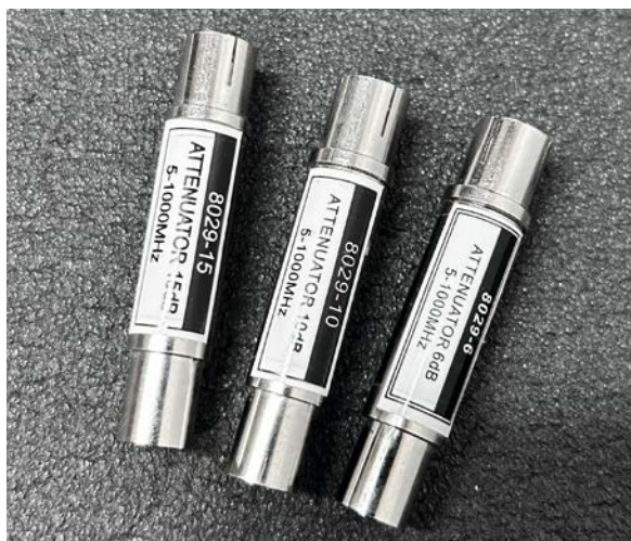
Bild 8: Drei Dämpfungsglieder zur Reduzierung des Ausgangssignalpegels, wenn 88 dB \mu V für Ihre Bedürfnisse zu hoch sind.
