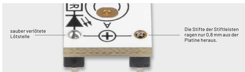
Bild 30: So werden die Stiftleisten korrekt angelötet.
