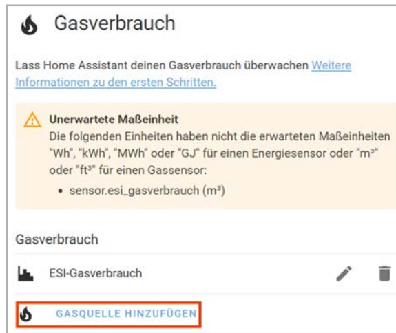
Bild 37: Hinzufügen des Gaszählers
