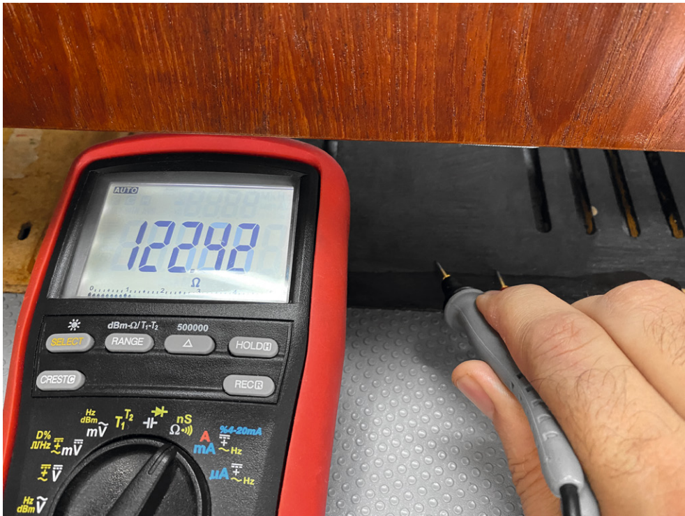
Bild 13: Die schwarze Farbe auf der Unterseite des Gehäuses ist leitfähig, um die Elektronik abzuschirmen.
