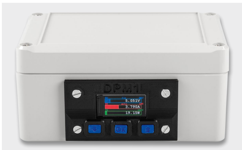
Bild 15: Das in ein Gehäuse eingebaute DPM1 mit einer 3D-Druck-Frontblende
