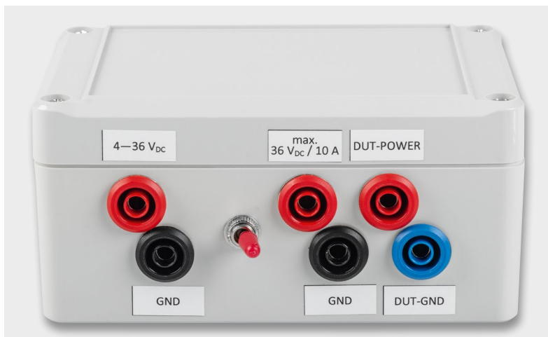
Bild 16: Die Anschlüsse der „Messbox“ auf der Rückseite
