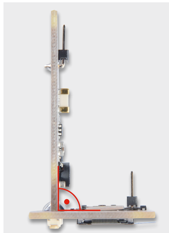
Bild 9: Die senkrecht zueinander aufgestellten Platinen
