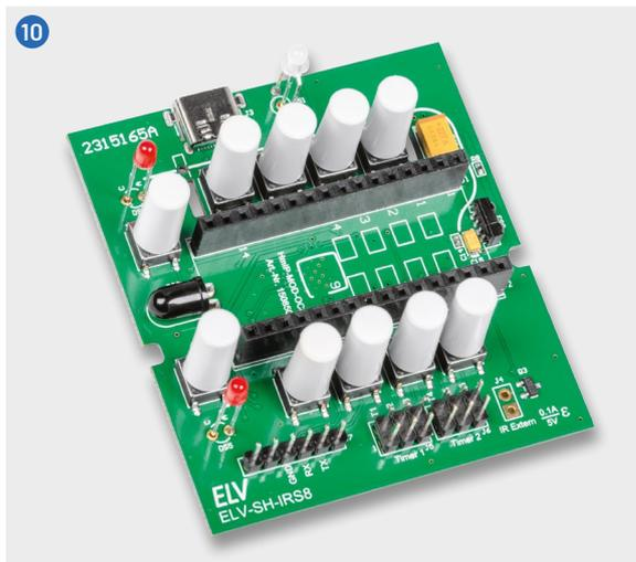
Nun werden die Tasterkappen auf die Taster S1-S10 gesetzt. **Dabei bitte vorsichtig vorgehen!** Durch die Höhe der Taster ist der Hebel recht groß und kann bei unvorsichtigem Aufsetzen zur Beschädigung des Tasters führen. Im Bild ist die fertig bestückte Platine zu sehen.
