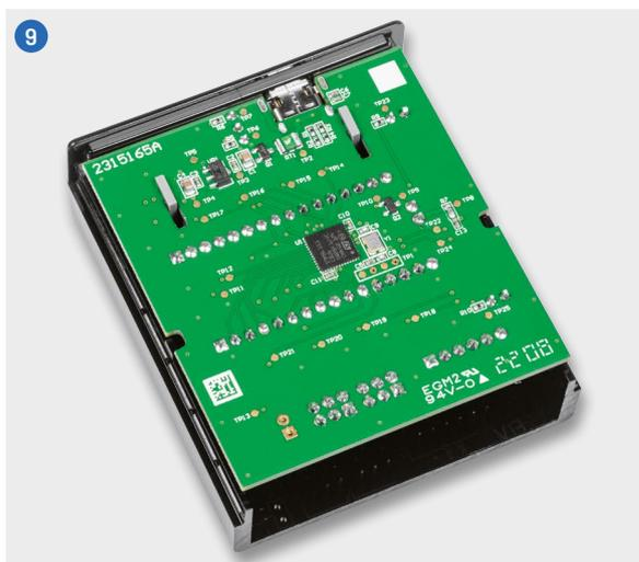
Alternativ kann man die LEDs einsetzen, die Platine in die Gehäusehälfte einlegen und auf eine glatte Oberfläche legen. Dabei muss man darauf achten, dass die LEDs in den entsprechenden Löchern sitzen. Dann kann man sie in dieser Position anlöten. So haben die LEDs später die passende Höhe für das Gehäuse.
