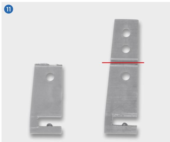
Für die optional verwendete Homematic IP Modulplatine HmIP-MOD-OC8 müssen zunächst die Antennenhalter gekürzt und montiert werden.
