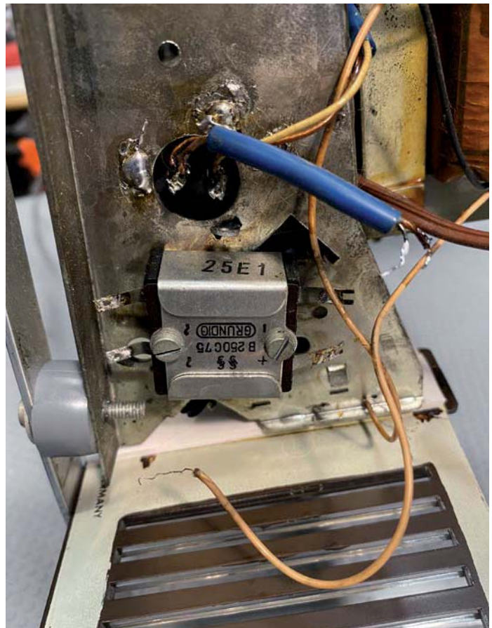
Bild 2: Der Selen-Gleichrichter, wie er im Radio eingebaut ist (links), und von allen Anschlüssen entfernt (rechts).
