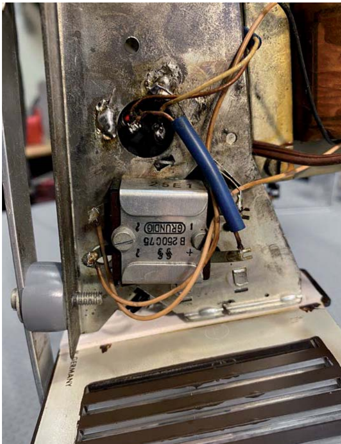
Bild 2: Der Selen-Gleichrichter, wie er im Radio eingebaut ist (links), und von allen Anschlüssen entfernt (rechts).
