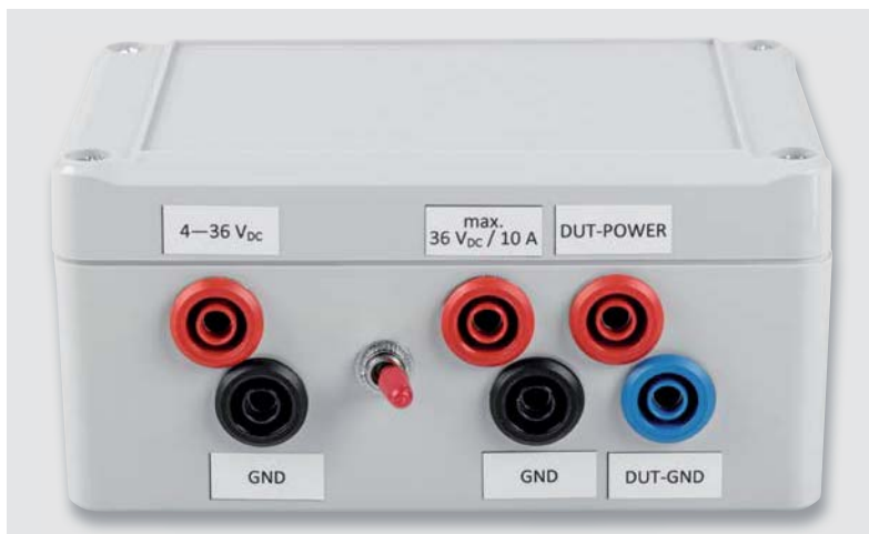
Bild 16: Die Anschlüsse der „Messbox“ auf der Rückseite
