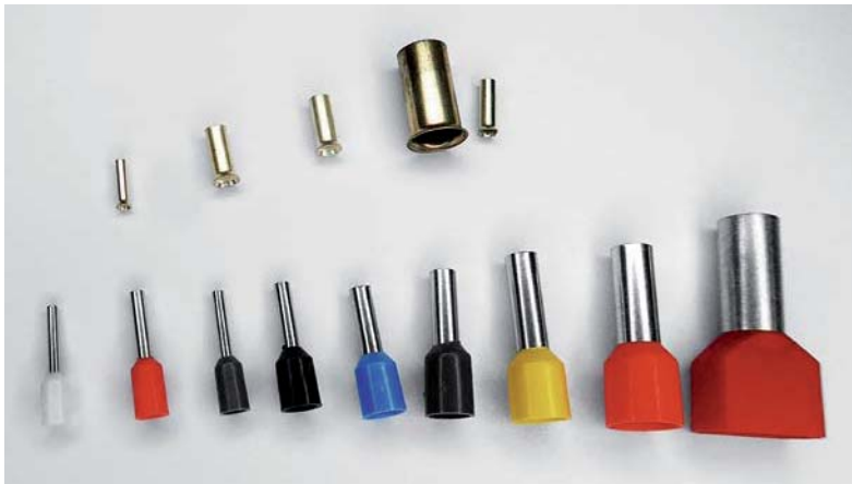
Bild 4: Aderendhülsen gibt es in verschiedenen Ausführungen, Bauformen, Durchmessern und Längen. Ihr Einsatz muss auf den Leiter und die benutzte Klemme abgestimmt sein. Rechts im Bild sieht man eine Aderendhülse für das Einsetzen von zwei Leitern.
