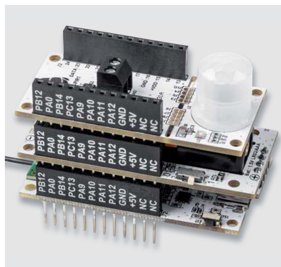
Bild 7: Modulstack bestehend aus Basismodul ELV-LW-Base (unten), ELV Powermodul LR03 (Mitte) und ELV Applikationsmodul ELV-AM-PIR1 (oben)
