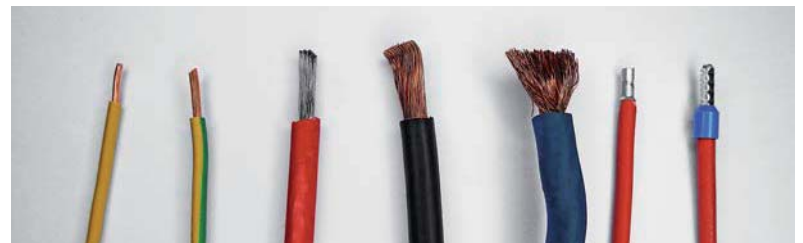
Bild 2: Starr und flexibel, ein-, mehr-, fein- oder feindrätig, mit oder ohne Aderendhülse - Drähte und Leiter gibt es in vielen Formen und für viele spezielle Anwendungen.
