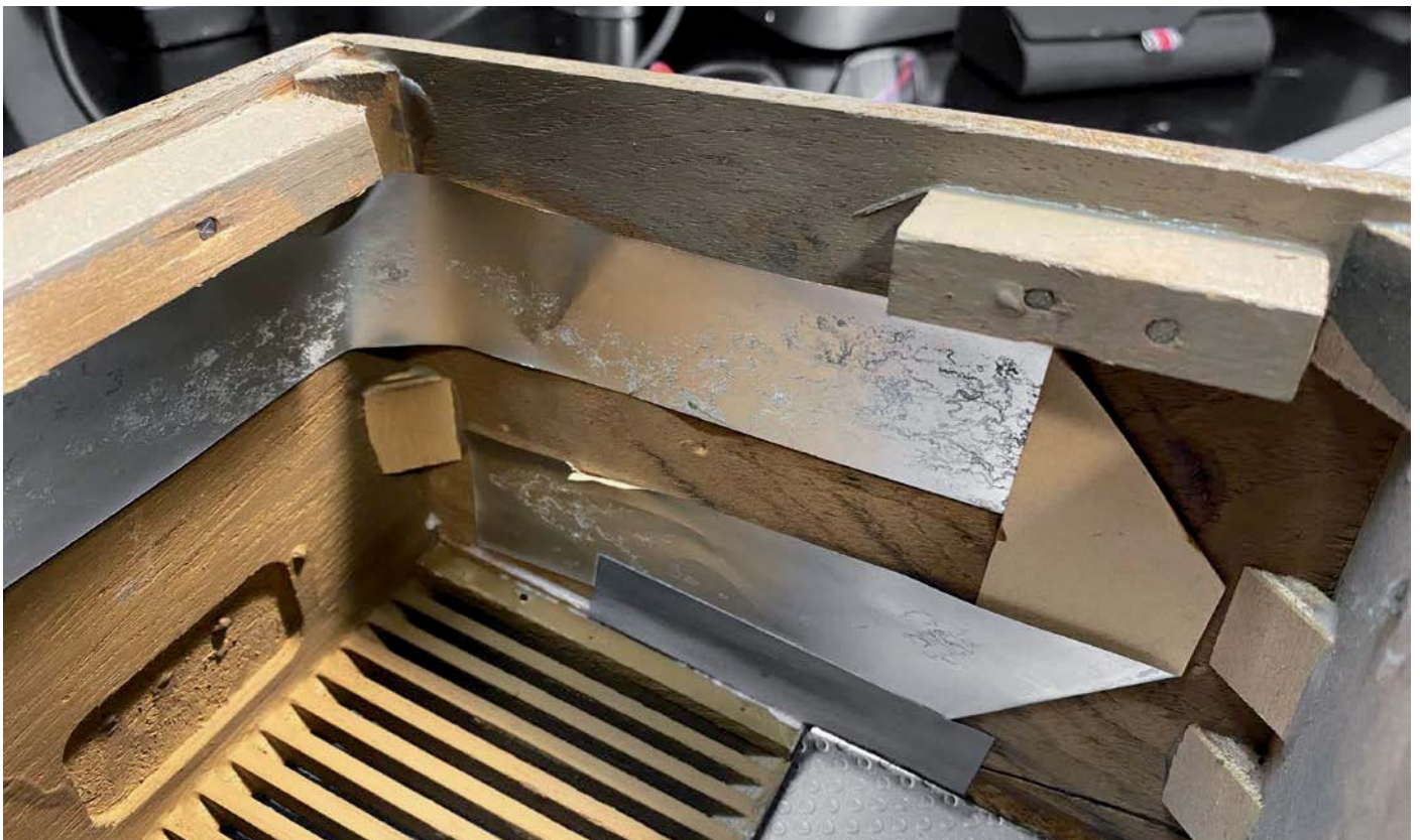
Bild 8: Die UKW-Dipol-Antenne ist offensichtlich in recht gutem Zustand.
