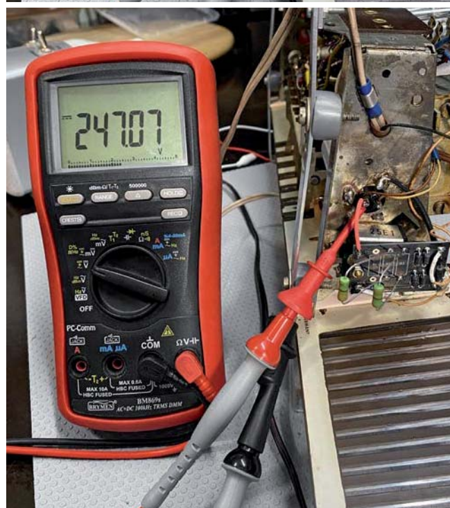
Bild 3: Durch die beiden 220- \Omega -Widerstände ergibt sich ein B+ von 256 Vdc, was ein wenig zu hoch ist. Zwei 330- \Omega -Widerstände führen zu einem guten Ergebnis.
