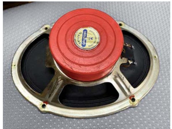
Bild 11: Der Lautsprecher benötigt außer einer leichten Reinigung nur sehr wenig Bearbeitung.
