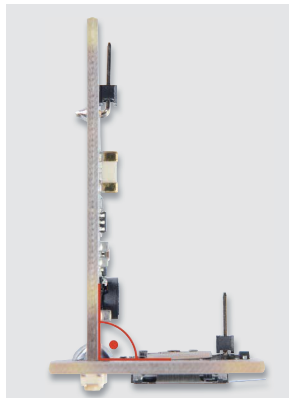
Bild 9: Die senkrecht zueinander aufgestellten Platinen
