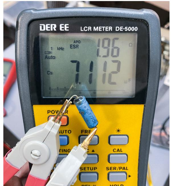
Bild 5: Die gemessenen Werte des ausgetauschten Diskriminator-kondensators
