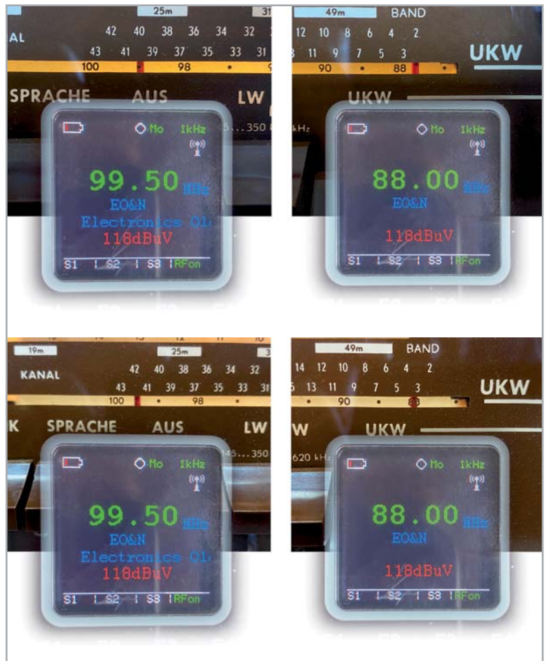
Bild 13: Genauigkeit der Senderskala vor und nach der HF-Abstimmung
