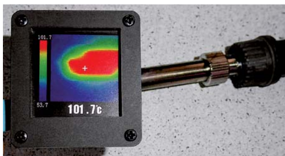
Bild 19: Mit dem Infrarot-Tempersensor MLX90614 lässt sich bereits eine rudimentäre Wärmebildkamera aufbauen – hier registriert sie das Aufheizen einer Lötspitzen.
