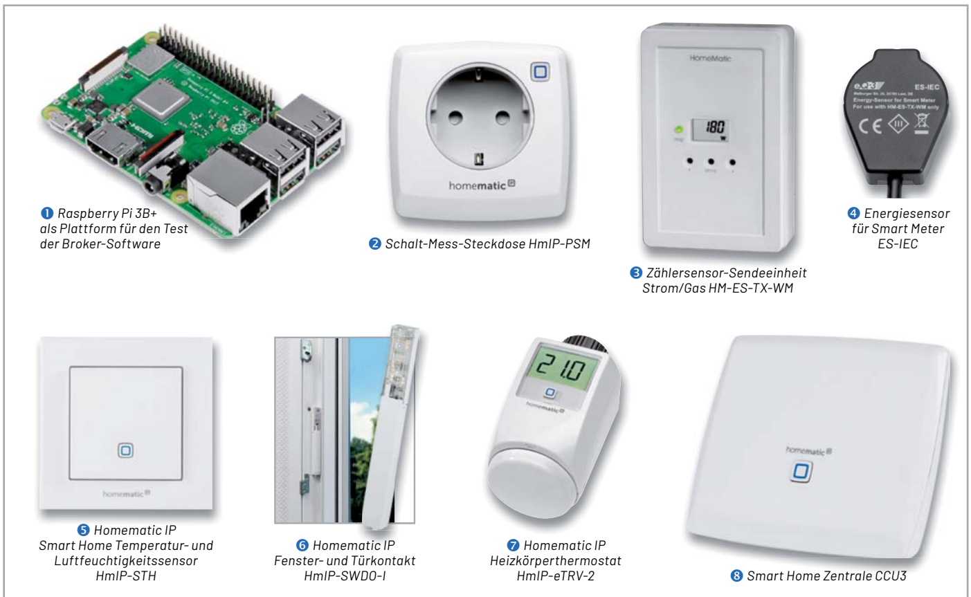
Bild 1: Überblick über alle Hardware-Komponenten für die Haussteuerungslösung
