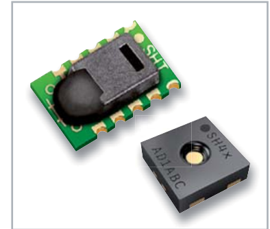
Bild 12: Klassiker für die Luftfeuchte- und Temperaturmessung: der Digitalsensor SHT11 und sein aktueller Nachfolger, der SHT40, der nur noch 1,5 x 1,5 x 0,5 mm groß ist Bilder: Sensirion
