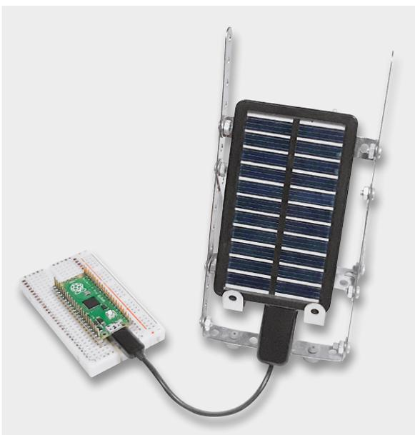
Bild 13: Autarker Datenlogger mit Solar-Powerbank
