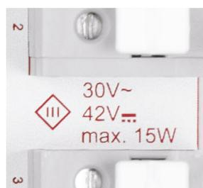
Bild 8: Auf der Platine sind die max. zulässigen Werte für die Ein- und Ausgangsspannung sowie die der Leistung angegeben.
