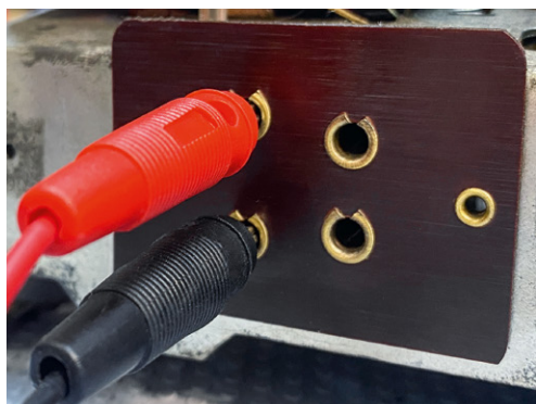
Bild 9: Das vom Signalgenerator erzeugte Testsignal (560 kHz, 30 % moduliert mit 400 Hz, minimale Amplitude) wird durch das Dämpfungsglied und die Dummy-Antenne geleitet und in die externe AM-Antennenbuchse des Radios eingespeist.
