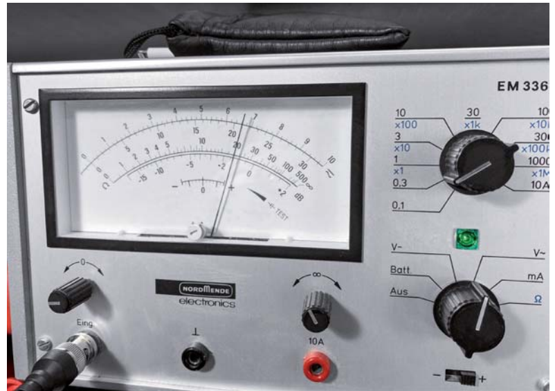
Bild 10: Ein analoges Voltmeter ist am besten geeignet, um die Antennenabstimmung durchzuführen.
