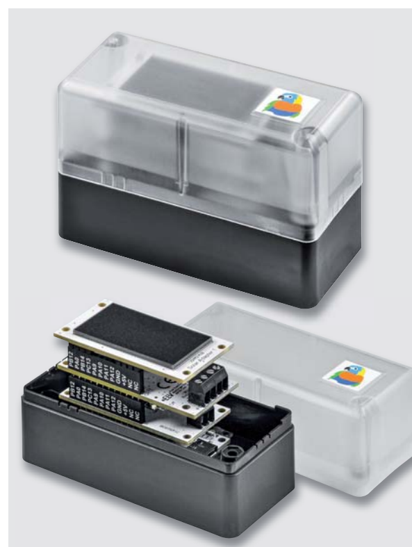
Bild 3: Passt exakt in das Gehäuse – der Modulstapel aus Bild 2 mit dem transparenten Deckel des modularen Gehäuses MH0101.
