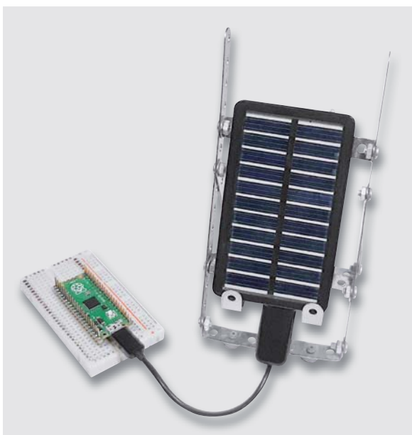
Bild 13: Autarker Datenlogger mit Solar-Powerbank
