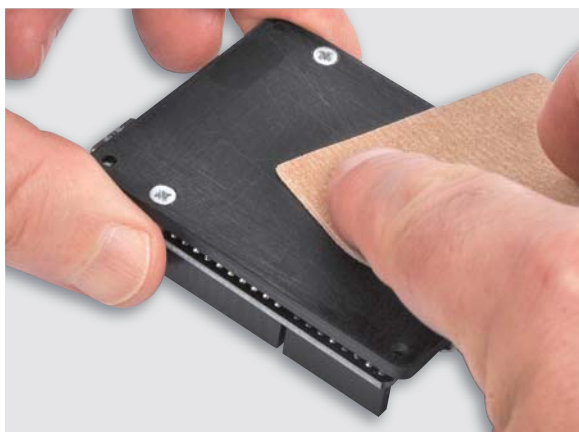
Bild 12: Die Oberfläche der Acrylplatte muss mit Schleifpapier aufgeraut werden.
