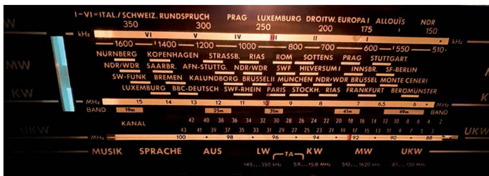
Bild 13: Prüfung der Abstimmung in der Mitte der Bänder zur Überprüfung der Genauigkeit. Bei LW (oberes Bild) ist die Ausrichtung bei 200 kHz absolut exakt. MW (mittleres Bild) ist auch am 800-kHz-Punkt genau richtig. Bei KW (unteres Bild) sehen wir eine leichte Fehlausrichtung bei 10 MHz.
