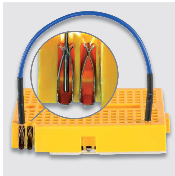
Bild 1: Die Buchsenkontakte eines Steckboards im Detail
