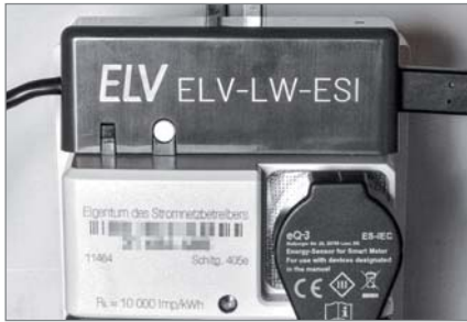
Anwendungsbeispiel mit Stromzähler
