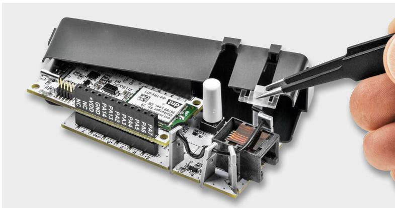
Bild 15: Montage der Gehäuseinnenschale und Einsetzen des Lichtleiters
