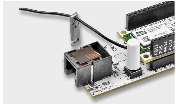
Bild 12: Die Antennenhalter werden einzeln aufgefädelt und eingesetzt.
