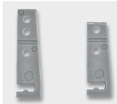
Bild 11: Links der ungekürzte Antennenhalter, rechts der gekürzte
