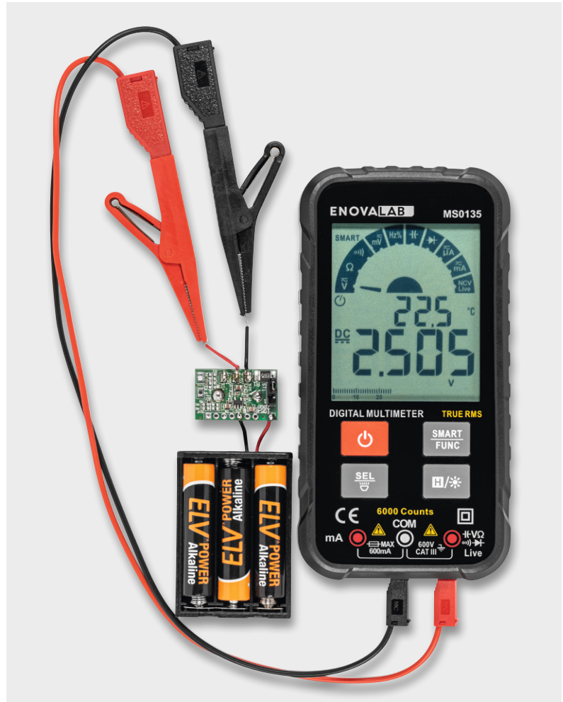
Bild 4: Ausgabe der ermittelten Spannung am Enovalab MS0135 mit dem PSR25. Adapterleitungen (Stecker/Stecker, Artikel-Nr. 069336/schwarz, Artikel-Nr. 069337/rot) von 2 auf 4 mm eignen sich, um z. B. Krokodilklemmen mit 4-mm-Buchse (Artikel-Nr. 043775/schwarz, Artikel-Nr. 043774/rot) oder andere Prüfspitzen anzuschließen.
