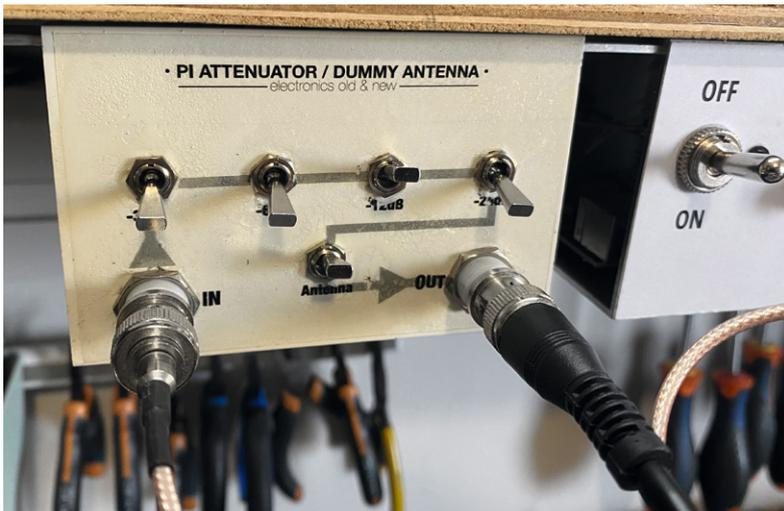
Bild 12: DIY-Dämpfungsglied zur Reduzierung der Signalamplitude
