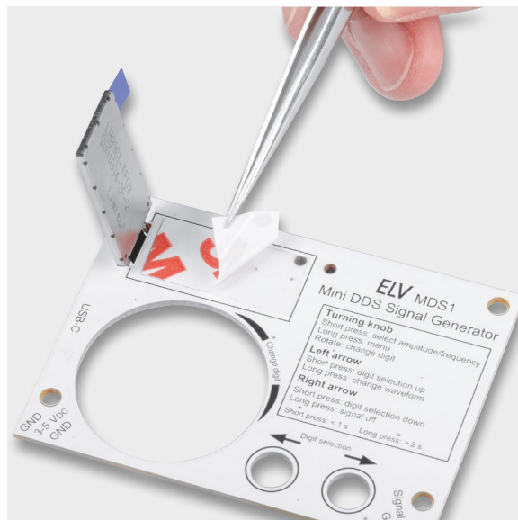
Bild 18: Die Schutzfolie des Doppelklebebands wird entfernt.
