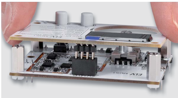
Bild 19: Basis- und die Displayplatine werden miteinander verbunden.
