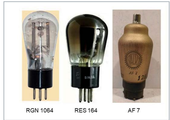
Bild 5: Die im Empfänger VE 301 häufig verwendeten Elektronenröhren. Anstelle der Gleichrichterröhre RGN 1064 wurde im VE 301 häufig auch ein Selen-Gleichrichter verwendet. Siehe dazu auch das Bild 3, oben rechts.
