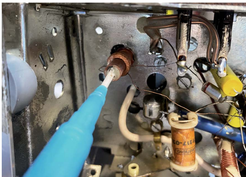
Bild 16: Die Spule (V) befindet sich auf der Unterseite in der Nähe der Antenneneingangsbuchse.
