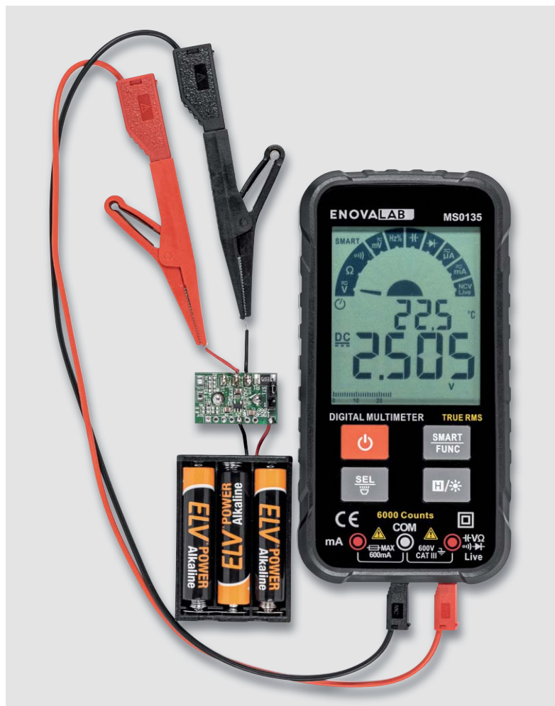
Bild 4: Ausgabe der ermittelten Spannung am Enovalab MS0135 mit dem PSR25. Adapterleitungen (Stecker/Stecker, Artikel-Nr. 069336/schwarz, Artikel-Nr. 069337/rot) von 2 auf 4 mm eignen sich, um z. B. Krokodilklemmen mit 4-mm-Buchse (Artikel-Nr. 043775/schwarz, Artikel-Nr. 043774/rot) oder andere Prüfspitzen anzuschließen.
