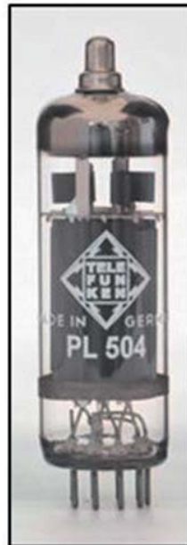
Bild 15: Tesla-Transformator mit einer Endpentode PL504 und NOVAL-Sockel. Die Anschlüsse sind dem Teilbild links unten zu entnehmen. Der Anodenanschluss befindet sich oben, getrennt von den übrigen Anschlüssen. Gespeist werden kann so ein Generator z. B. von einem Stecker-netzteil. Von der Teslaspule können imposante Lichtblitze austreten.
