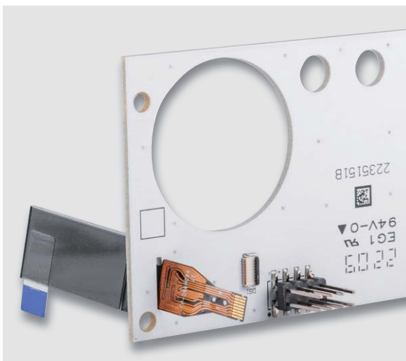
Bild 15: Das durchgeführte TFT-Anschlusskabel
