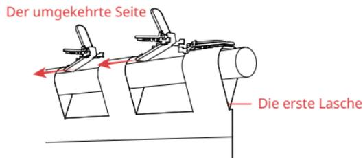
Achten Sie darauf, dass alle anderen Clips in entgegengesetzter Richtung zum ersten Clip angebracht werden. Stellen Sie sicher, dass alle Clips oben auf der Stange sitzen und miteinander ausgerichtet sind.
