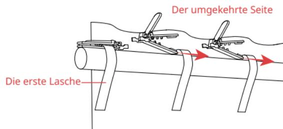
Achten Sie darauf, dass alle anderen Clips in entgegengesetzter Richtung zum ersten Clip angebracht werden. Stellen Sie sicher, dass alle Clips oben auf der Stange sitzen und miteinander ausgerichtet sind.
