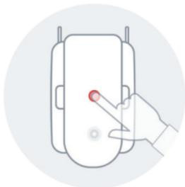
Halten Sie die Reset-Taste 15 Sekunden lang gedrückt, bis die LED-Leuchte aufleuchtet, und lassen Sie dann die Taste los.
