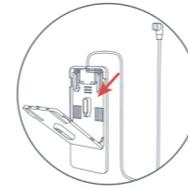
1 Öffnen Sie die hintere Abdeckung, um das Netzkabel zu entfernen
