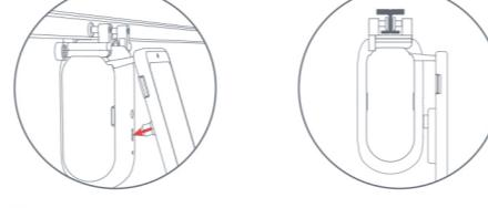
2 Setzen Sie den Rahmen in den Spalt zwischen den "Ohren" des SwitchBot-Vorhangs und dem Hauptkörper ein, um sicherzustellen, dass das Solarpanel sicher aufgehängt ist.
