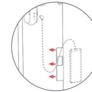
3 Befestigen Sie ein weiteres Stück Klettband mit Klebstoff auf der Rückseite Ihres Vorhangs. Die Einbaulage erfordert zwei Dinge: 1. direkte Sonneneinstrahlung; 2. Die Entfernung zum intelligenten Vorhang sollte die Länge des eingebauten Kabels nicht überschreiten, dann warten Sie 5 Stunden um eine ausreichende Haftung zu gewährleisten.
