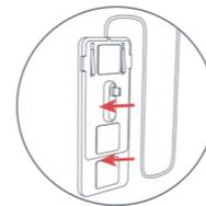
2 Bringen Sie drei Blätter Klettverschluss mit Klebstoff auf der Rückseite des Solarpanel an. und 5 Stunden warten, bis sie gut haften.
