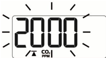
Nastavení upozornění na vysokou koncentraci CO 2 (výchozí hodnota 2000 PPM)
