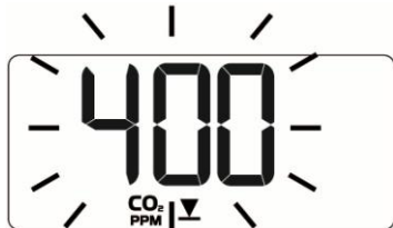
Nastavení upozornění na nízkou koncentraci CO 2 (výchozí hodnota 400 PPM)
