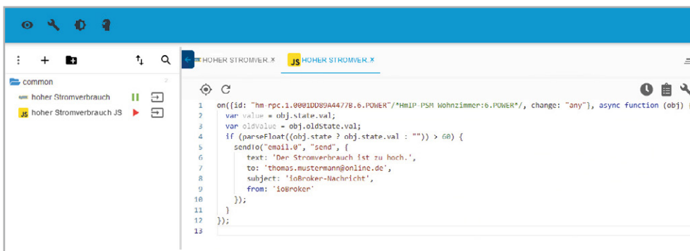
Bild 14: Generierter JavaScript-Code aus der Blockly-Visualisierung
