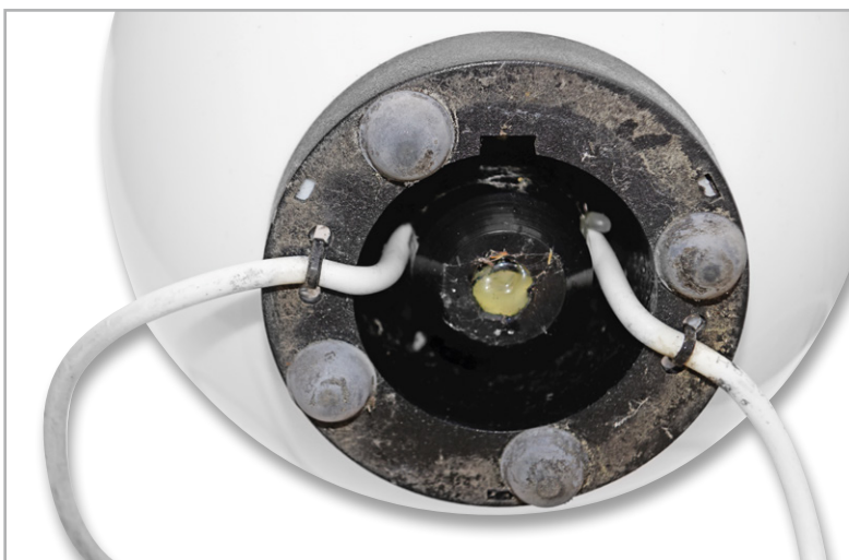
Bild 13: Anschlussleitungen und Zugentlastung
