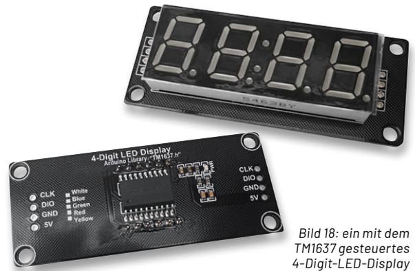
Bild 18: ein mit dem TM1637 gesteuertes 4-Digit-LED-Display
