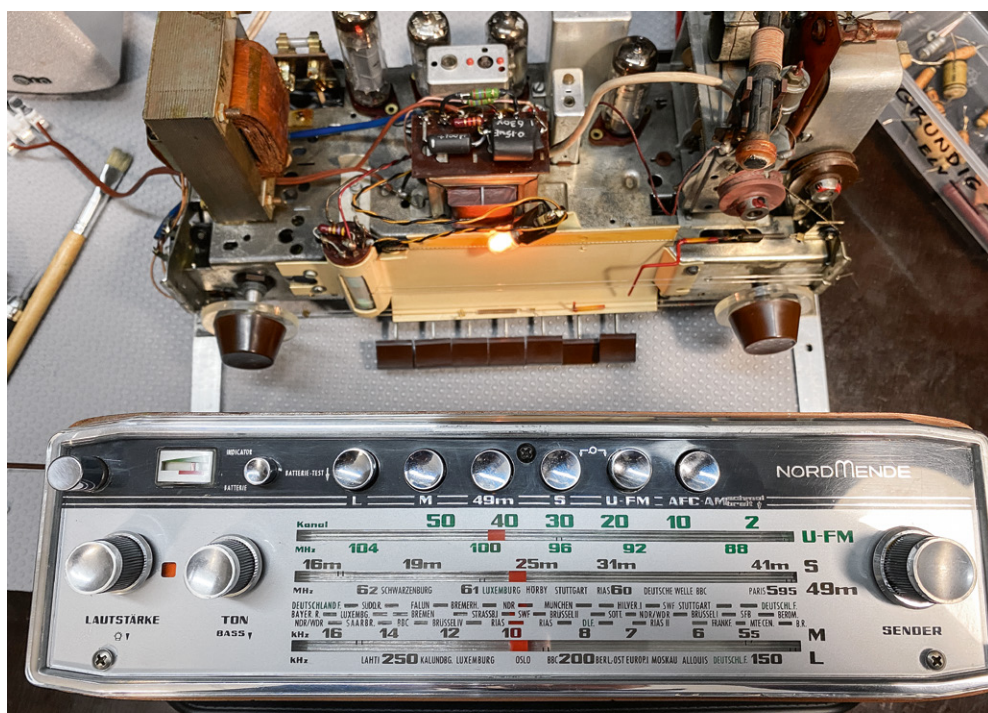
Bild 12: Verwendung eines anderen Radios zur Erkennung des Oszillatorsignals
