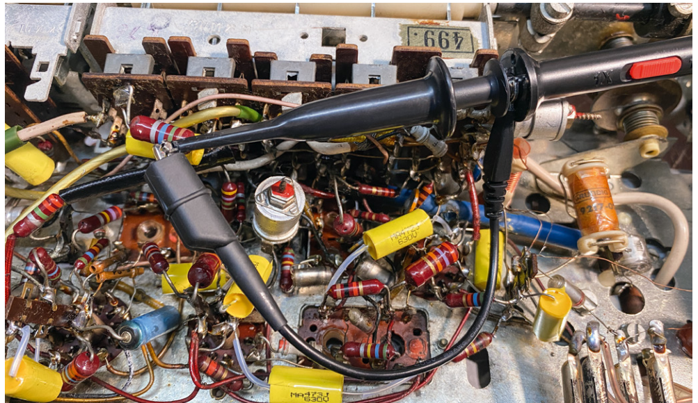
Bild 13: Kurzgeschlossener Tastkopf am Oszillatorteil des Radios
