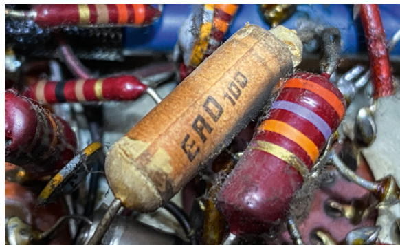
Bild 5: Der Zustand der Papierkondensatoren spricht für sich selbst.
