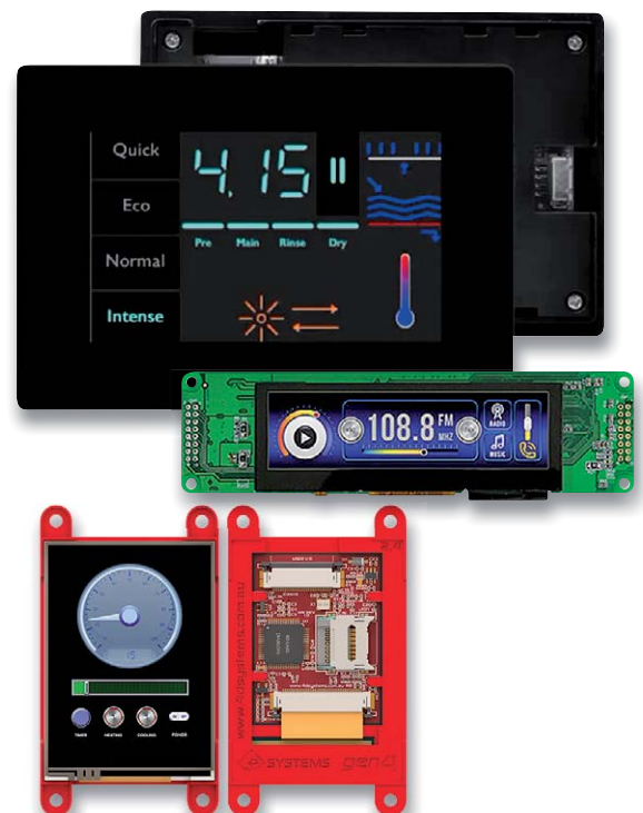
Bild 19: Smart-Displays entlasten die Ressourcen des Wirtssystems. Bilder: Nextion, Winstar, 4D Systems
