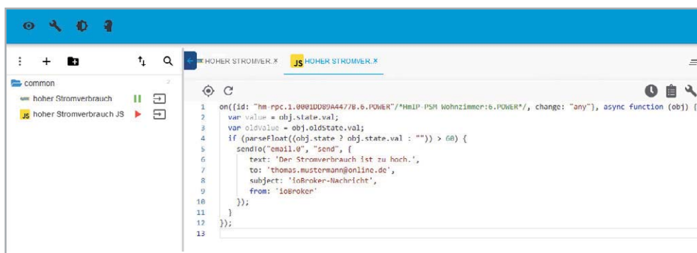
Bild 14: Generierter JavaScript-Code aus der Blockly-Visualisierung
