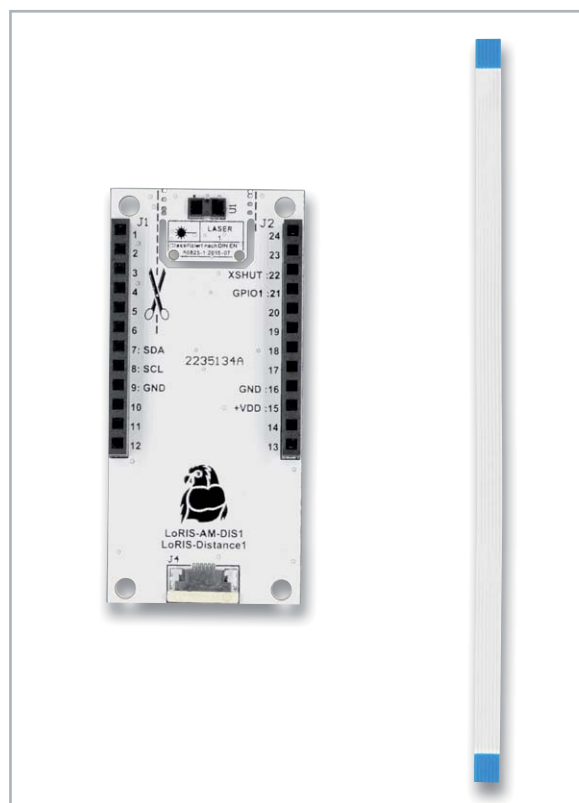
Bild 6: Lieferumfang des LoRIS-Distance1 mit 10 cm Flachbandkabel
