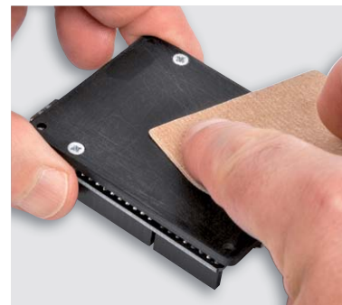
Bild 16: Die Oberfläche der Acrylplatte muss mit Schleifpapier aufgeraut werden.
