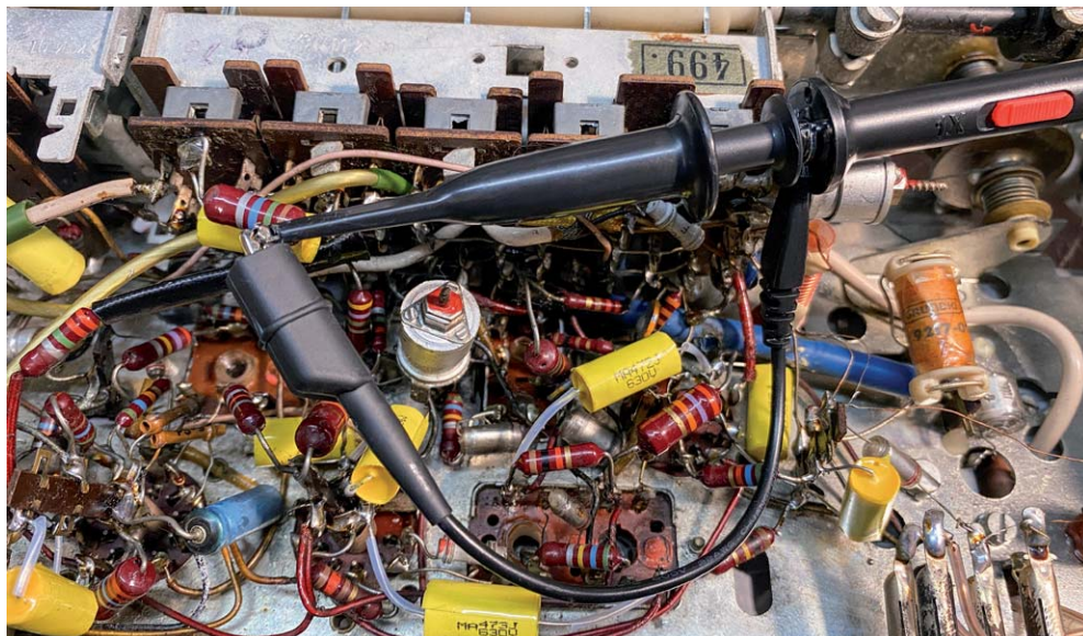
Bild 13: Kurzgeschlossener Tastkopf am Oszillatorteil des Radios
