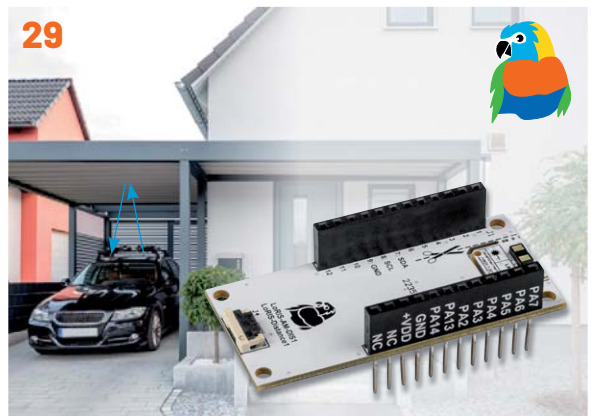
LoRIS Applikationsmodul Abstandsüberwachung
