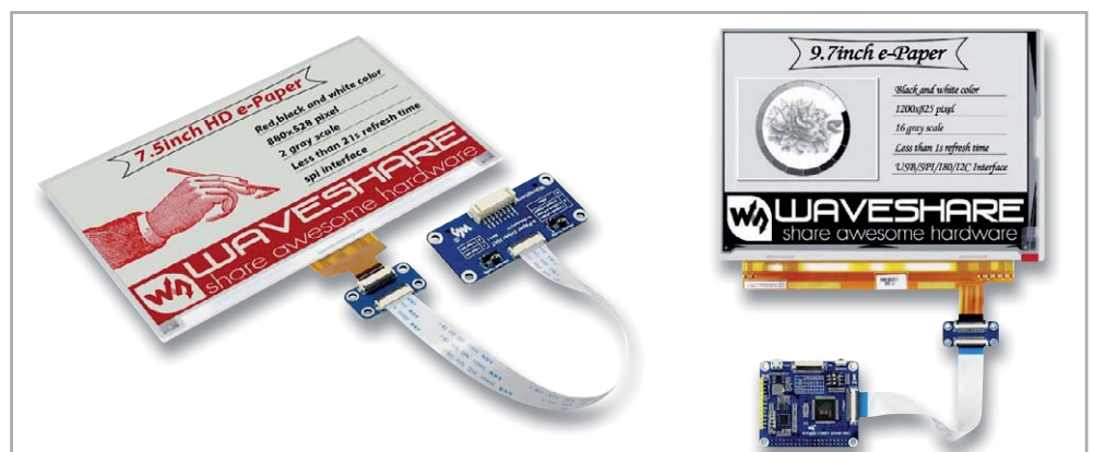
Bild 13: Passt direkt – HATS für den Anschluss eines ePaper-Displays an den Raspberry Pi und den Arduino. Bilder: Waveshare
