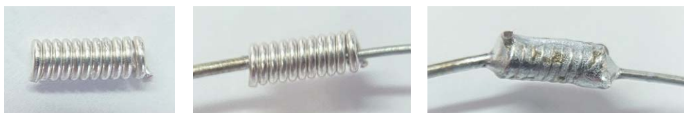
Bild 7: Eine einfache Möglichkeit, Bauteile zu ersetzen, ohne die Lötösen zu beschädigen
