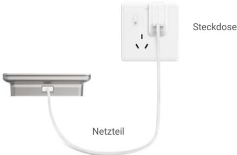
Schließen Sie den Bildschirm über einen Netzadapter (5V 2A, separat erhältlich) an die Steckdose.
