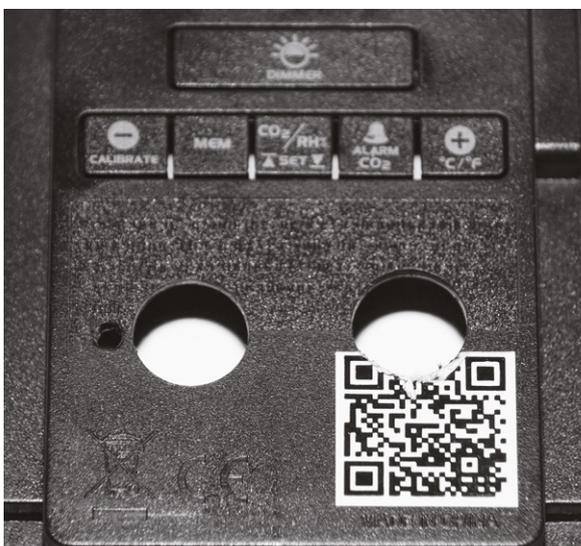
Bild 6: Bearbeitung des technoline-WL1030-Gehäuses
