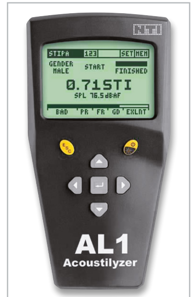
Bild 16: Direkte Messung der Sprachverständlichkeit STI-PA (gemäß IEC 60268-16). Auf dem Display des Messgeräts wird gerade ein Messwert von 0,71 STI angezeigt, wobei der Schalldruckpegel SPL während der Messung 76,5 dB(A) betrug. Auf der unteren Skala erkennt man zusätzlich noch die Bewertung: BAD - POOR - FAIR - GOOD - EXCELLENT. Der Messwert 0,71 wird dort als „excellent“ bewertet. (Werkfoto: Schalltechnik Süd, Regensburg)
