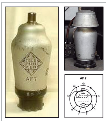
Bild 3: HF-Pentode AF 7(1935) mit Außenkontakt für das Steuergitter G1.
