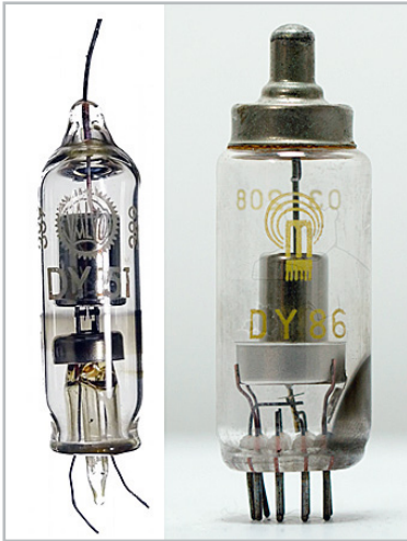
Bild 12: Hochspannungs-Gleichrichterdioden, Heizspannung: 1,4 V, Heizstrom: 530 mA Links: DY 51 (älterer Röhrentyp; U_{\text{Sperr}} = 15 \text{ kV} ), Rechts: DY 86 ( U_{\text{Sperr}} = 20 \text{ kV} )
