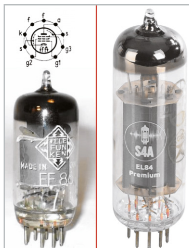
Bild 4: Vorverstärkerpentode EF 86 und Endpentode EL 84.
