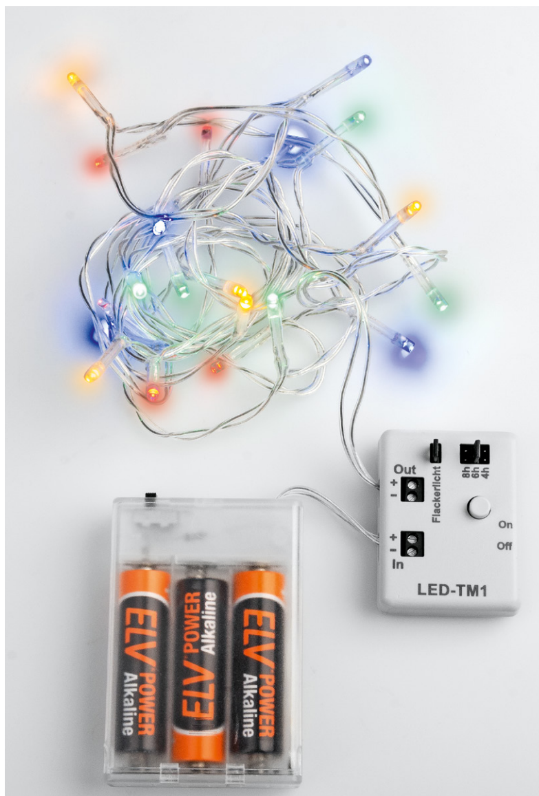
Bild 2: Anwendungsbeispiel mit dem LED-Timermodul
