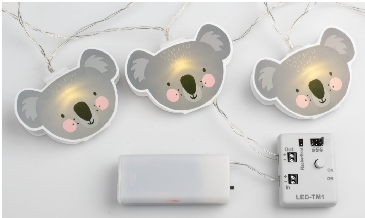
Bild 17: Anwendungsbeispiel batteriebetriebene LED-Lichterkette
