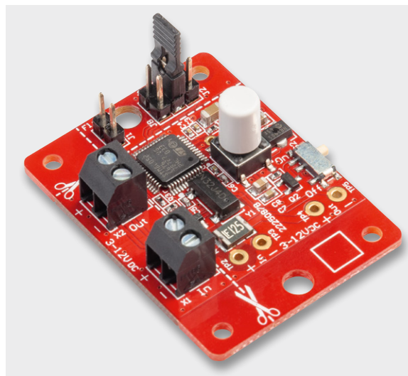
Bild 8: Fertig bestückte Platine mit per Jumper ausgewähltem Zeitintervall von sechs Stunden
