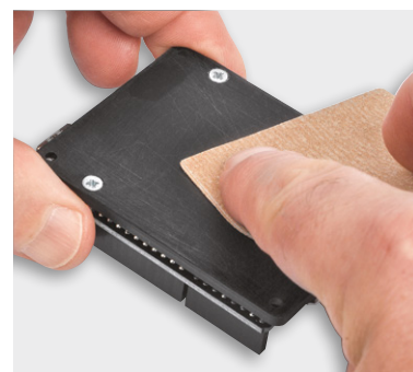
Bild 9: Die Oberfläche der Acrylplatte muss mit Schleifpapier aufgeraut werden.
