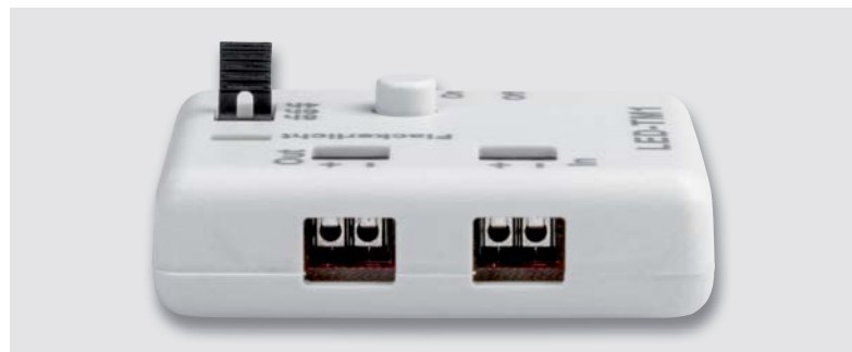
Bild 16: Seitlicher Kabelanschluss für die Last (links) und die Spannungsversorgung (rechts)
