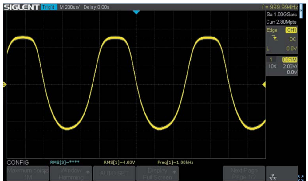
Bild 11: Offensichtliche Verzerrung bei 4,00 \text{ V}_{\text{RMS}} Ausgangspegel
