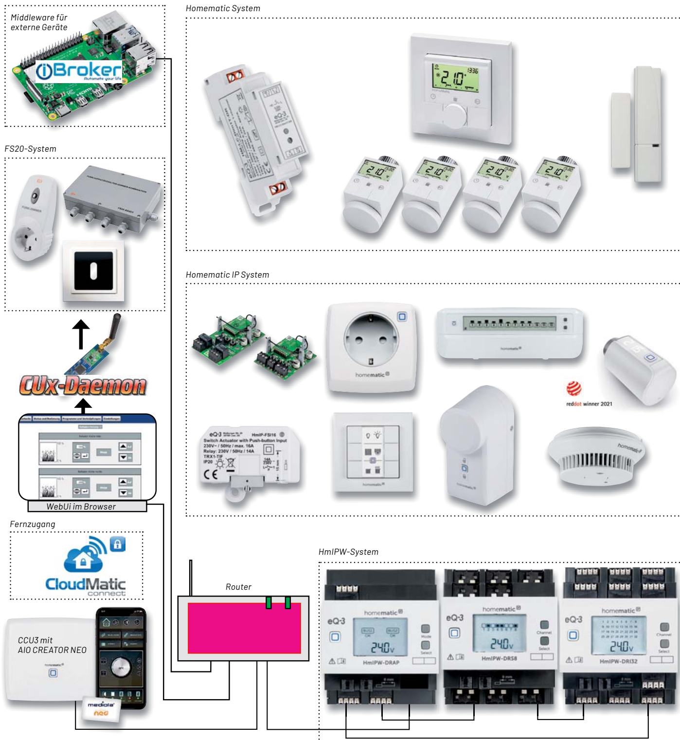
Bild 8: Mit der CCU3 eröffnen sich dem Nutzer nahezu unbegrenzte individuelle Konfigurations-, Bedien- und Visualisierungsmöglichkeiten sowie die Einbindung externer Technik. Logos: CloudMatic, ioBroker, CuX-Daemon
