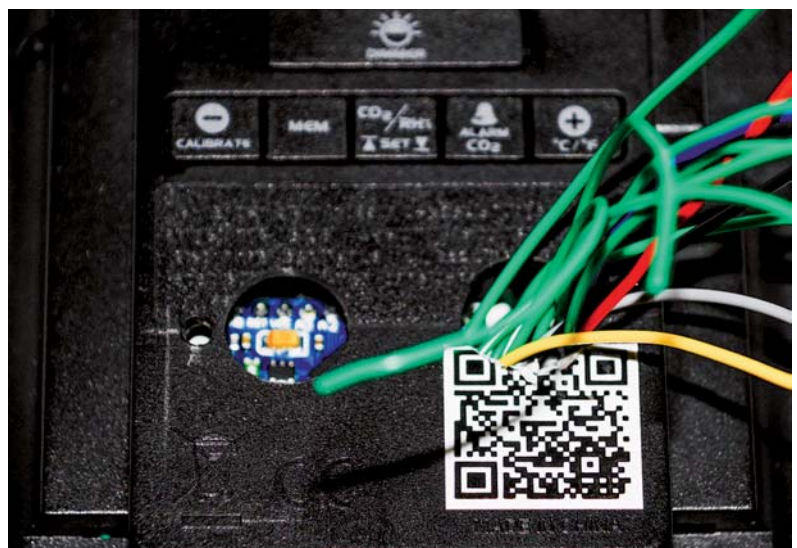
Bild 7: Durchführung der Kabel durch die Rückwand des technoline WL1030
