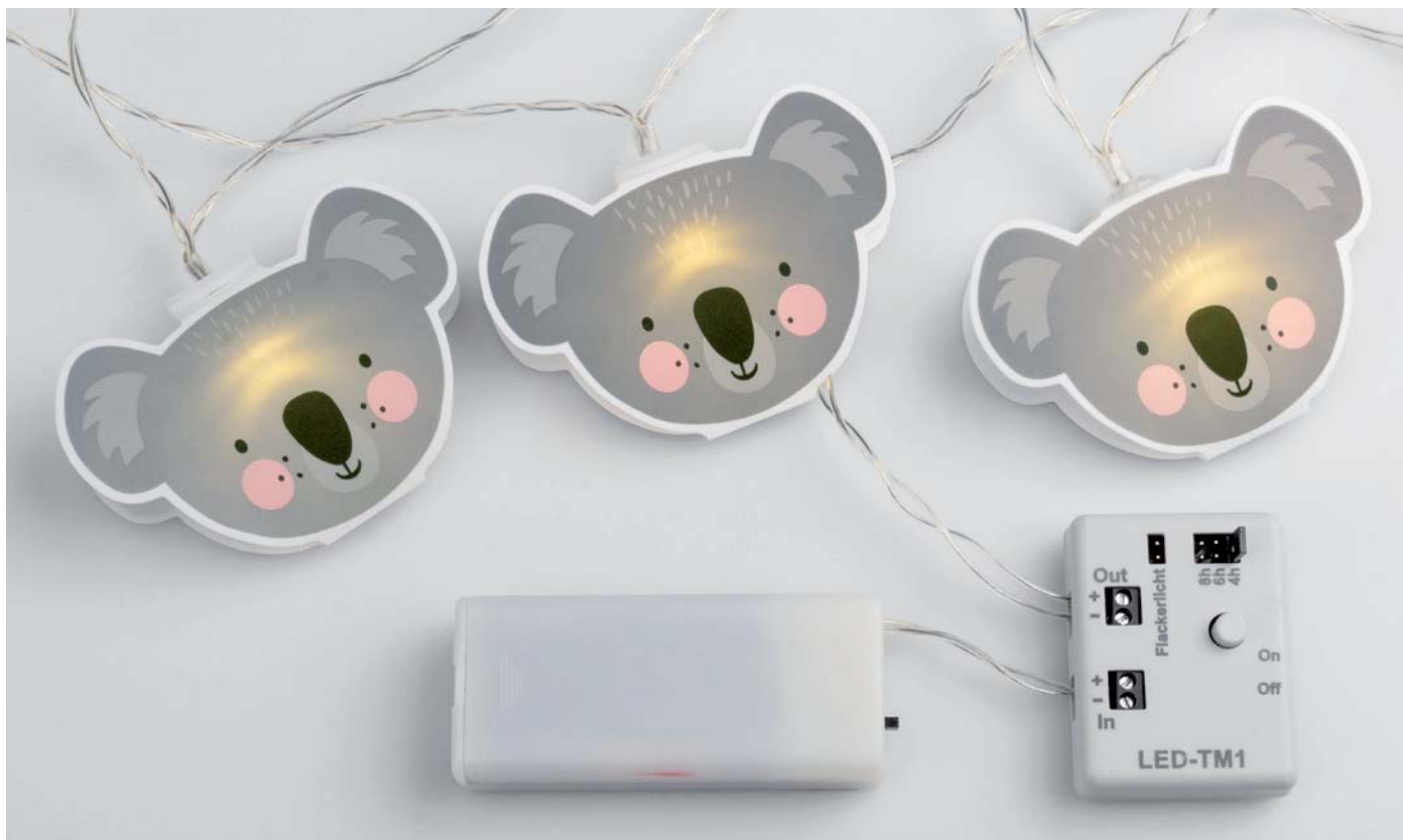
Bild 17: Anwendungsbeispiel batteriebetriebene LED-Lichterkette
