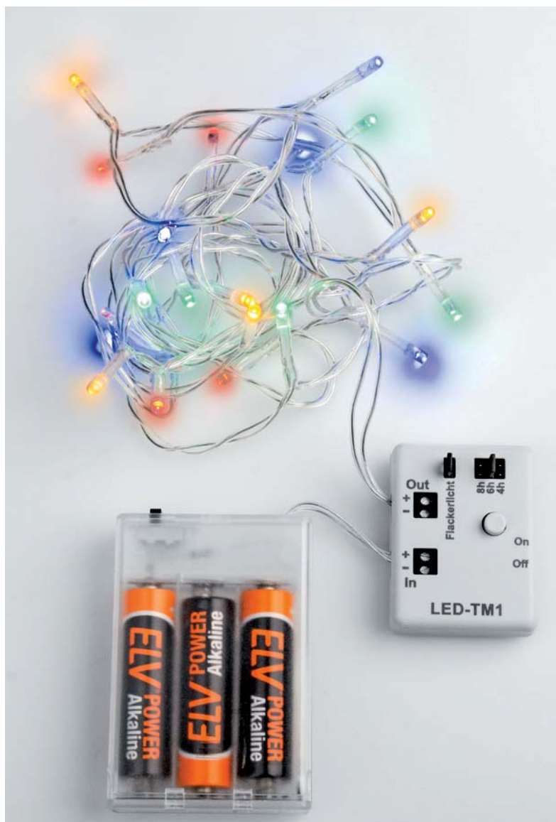
Bild 2: Anwendungsbeispiel mit dem LED-Timermodul
