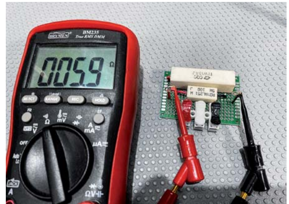
Bild 9: Blindlast mit parallel geschalteten Widerständen
