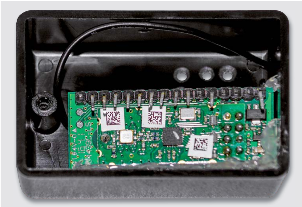
Bild 8: Vorbereitung und Einkleben des Moduls in das Zusatzgehäuse
