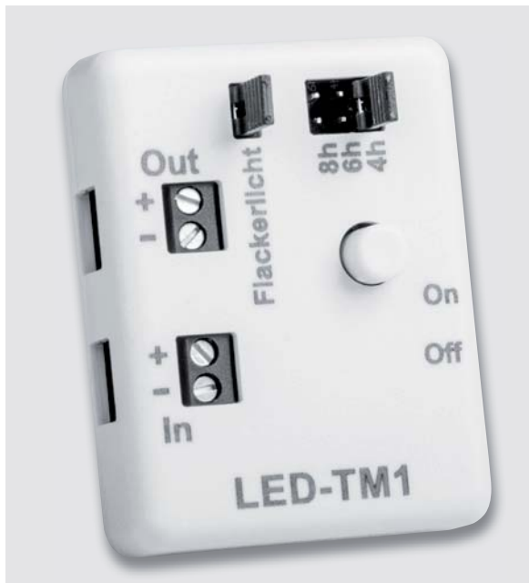
Bild 14: Fertig aufgebautes LED-Timermodul im Gehäuse
