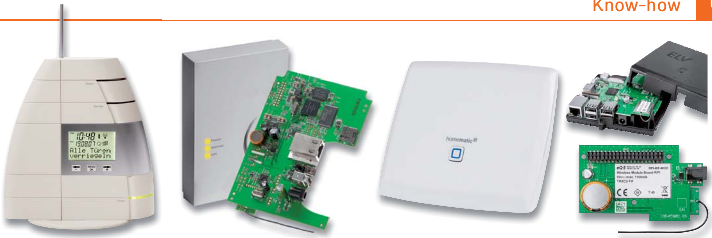
Bild 1: Die verschiedenen CCU-Generationen: CCU1, CCU2, CCU3 und das Funkmodul für den Raspberry Pi als Zentrale
