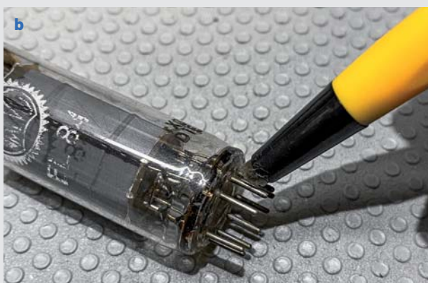
Bild 6: Reinigung der Röhren und Röhrenfassungen
