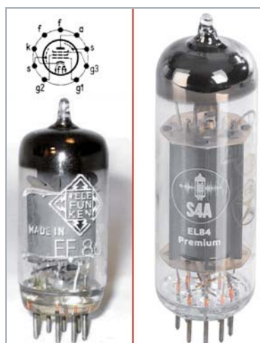
Bild 4: Vorverstärkerpentode EF 86 und Endpentode EL 84.
