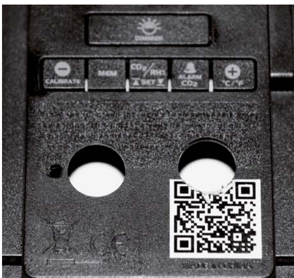
Bild 6: Bearbeitung des technoline-WL1030-Gehäuses
