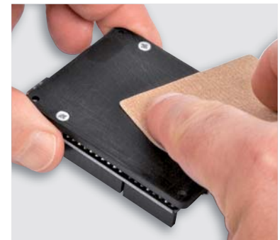
Bild 9: Die Oberfläche der Acrylplatte muss mit Schleifpapier aufgeraut werden.
