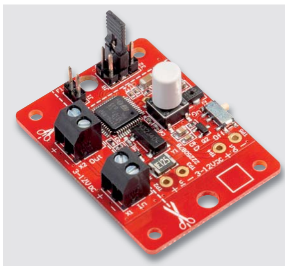
Bild 8: Fertig bestückte Platine mit per Jumper ausgewähltem Zeitintervall von sechs Stunden
