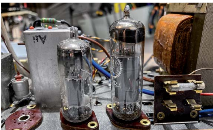
Bild 2: Audioröhren nach der Reinigung
