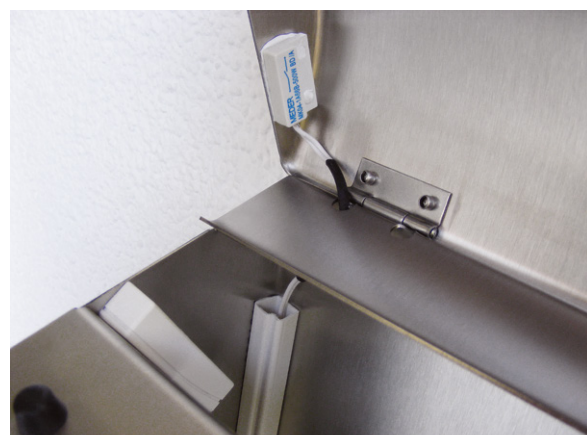
Bild 2: Reed-Kontakte und Magnete werden am Briefkastendeckel und an der Briefkastenklappe angebracht.
