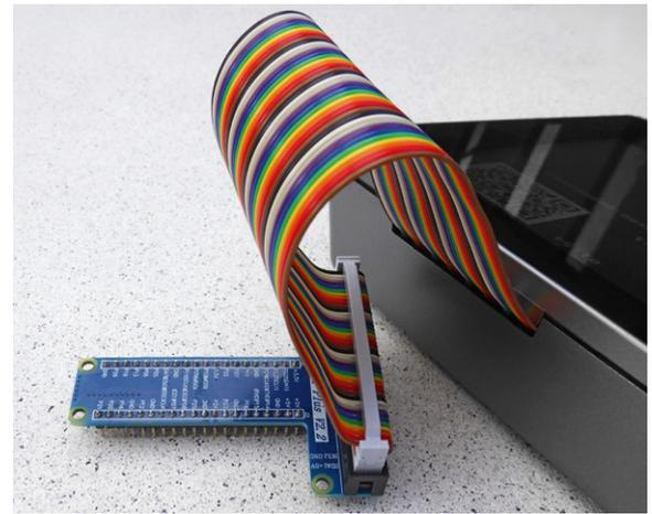
Bild 5: Der GPIO-Port ist beim RasPad 3 hinten über ein Kabel auf den Breadboard-Adapter geführt.
