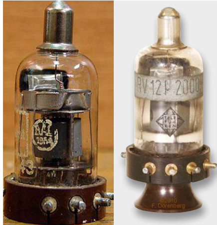
Bild 13: Verstärkerröhre RV 12 P 2000 mit Aussenkontakten, eine ursprünglich für militärische Geräte der Wehrmacht entwickelte Röhre (Pentode) mit einer Heizspannung von 12,6 Volt, Heizstrom 0,075 A, und Abmessungen: 20 mm \varnothing x 46 mm. Nach dem Ende des 2. Weltkrieges stand dieser Röhrentyp noch in großen Mengen zur Verfügung, so dass damit nicht nur die ersten Rundfunkempfänger der Nachkriegszeit entstanden, sondern auch die ersten netzbetriebenen Hörgeräte hergestellt wurden [4]. Die rechte Darstellung zeigt eine P 2000 mit einem abschraubbaren Knopf zum Herausziehen der Röhre aus ihrer speziellen Patronenfassung.
