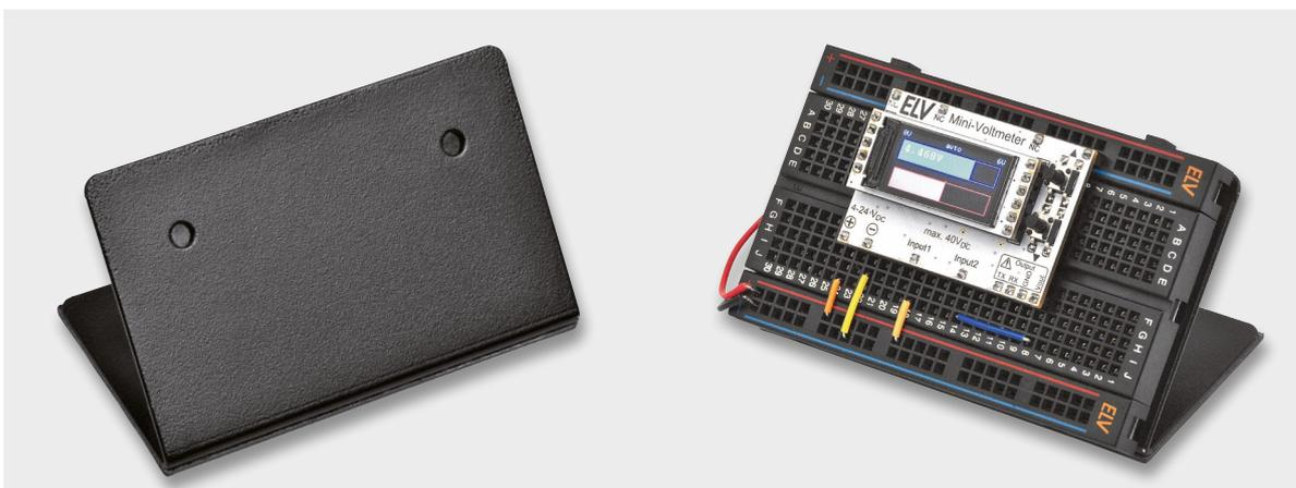
Bild 8: Metallwinkel für das MEXB-System, rechts im Einsatz mit dem Minivoltmeter MVM1 in Verbindung mit einem Steckboard
