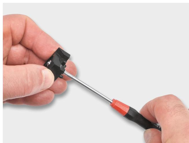
Bild 11: So wird die Mutter mithilfe der Schraube in den Gehäusefuß „hineingezogen“.
