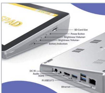
Bild 4: Alle Ports, der SD-Kartenslot und die Bedienelemente sind an den Seiten herausgeführt (RasPad 3).
