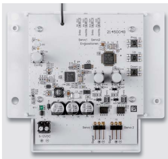
Bild 14: Befestigung der Platine in der Gehäuseunterschale
