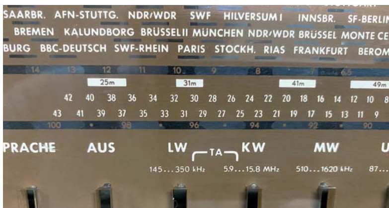
Bild 3: Um TA auszuwählen, müssen LW und KW gleichzeitig gedrückt sein.
