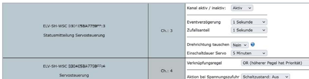
Bild 22: Einstellmöglichkeiten für Drehrichtung und Einschaltdauer der Servos (im Bild nur für Servo 1)
