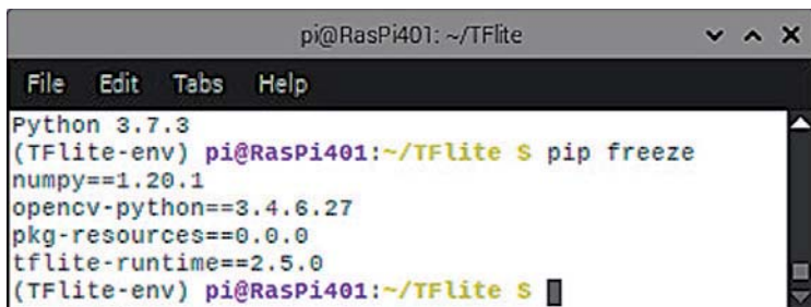
Bild 2: Die Pakete sind erfolgreich installiert.
