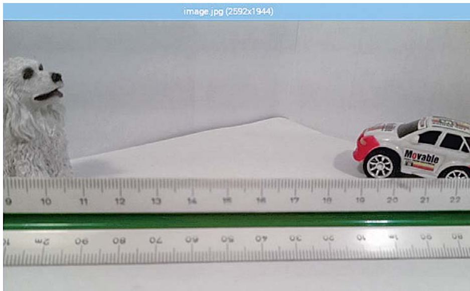
Bild 3: Gesichtsfeld der Standard-PiCam (ca. 76° horizontal)
