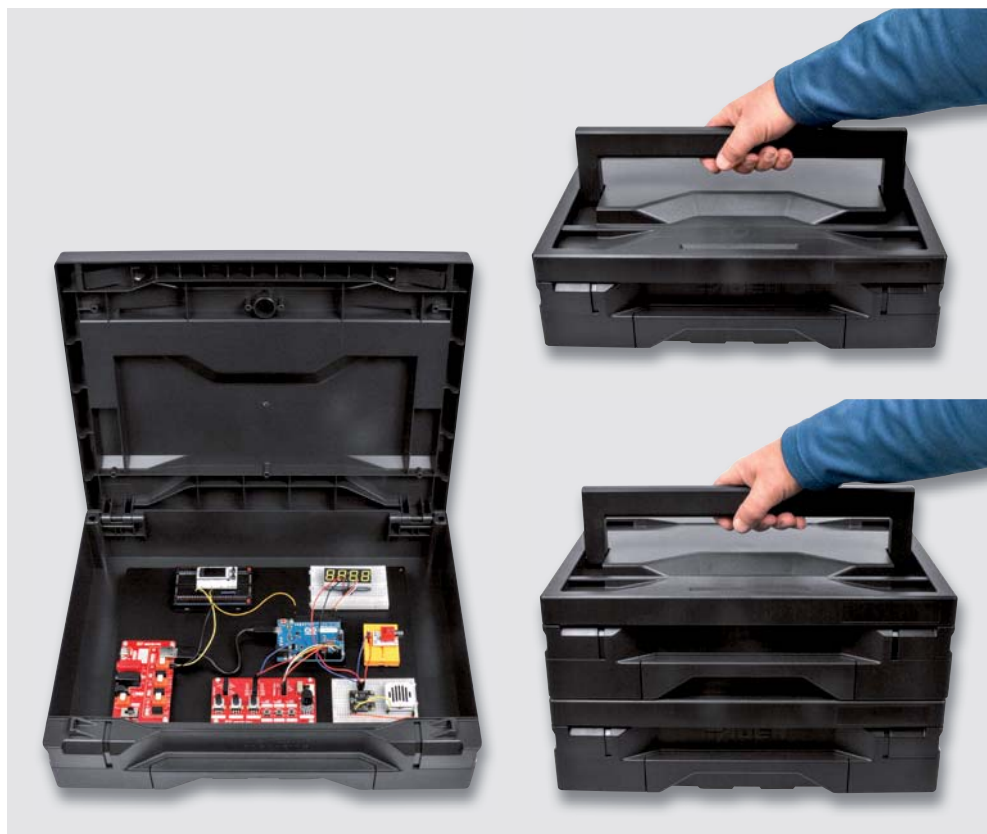
Bild 9: Passende Transportbox für das MEXB-System. Wie im rechten Bild zu sehen, sind die Boxen stapelbar und durch Klicksystem miteinander zu verbinden.
