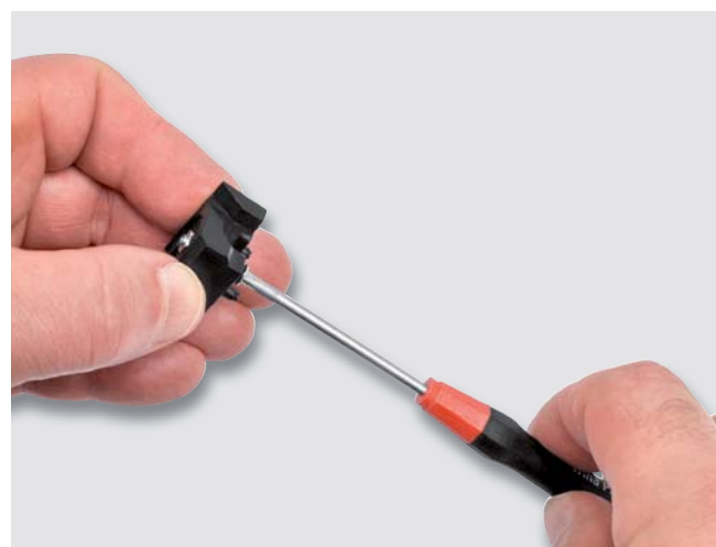
Bild 11: So wird die Mutter mithilfe der Schraube in den Gehäusefuß „hineingezogen“.
