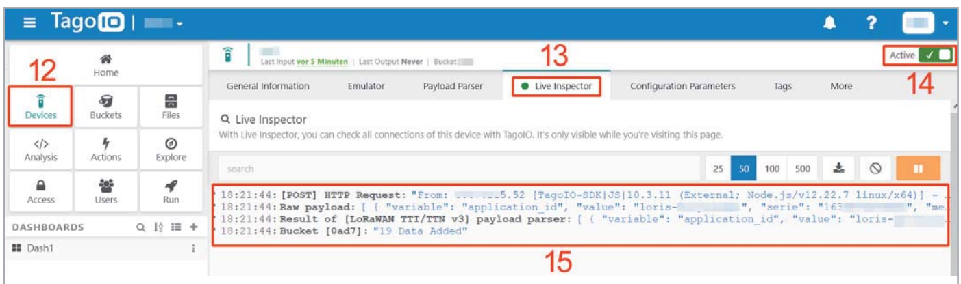
Bild 9: Anzeige der bei Tago.io eingehenden Daten im Live Inspector
