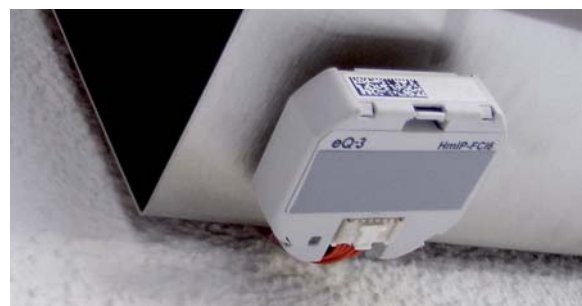
Bild 4: Der HmIP-FCI6 kann z.B. an der Unterseite des Briefkastens montiert werden.
