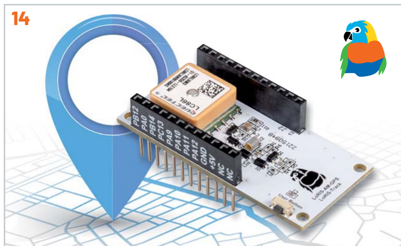
LoRIS Applikationsmodul GPS für LoRaWAN
