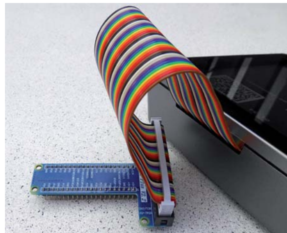
Bild 5: Der GPIO-Port ist beim RasPad 3 hinten über ein Kabel auf den Breadboard-Adapter geführt.
