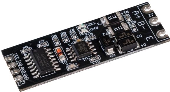
Dieser UART TTL zu RS485 Konverter, ermöglicht Ihnen, Ihren Singleboard-computer um eine RS485 Schnittstelle zu erweitern. Die Stiftleiste liegt bei und ist nicht angelötet.
