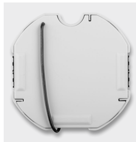
Bild 7: So wird die Antenne um das Gehäuse herumgeführt und im Gehäusedeckel fixiert.
