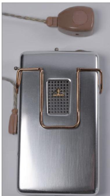
Bild 6: Taschen-Hörgerät mit ansteckbarem Außenhörer und zwei Übertragern im Inneren, schon mit Gegentakt-Endstufe, Typ 324 Super von Siemens-Reiniger, Erlangen.
