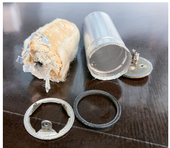
Bild 4: Der entfernte Teil des alten Kondensators
