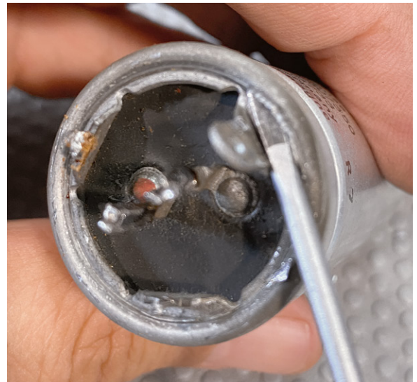
Bild 3: Anheben der Ummantlung vom Sockel
