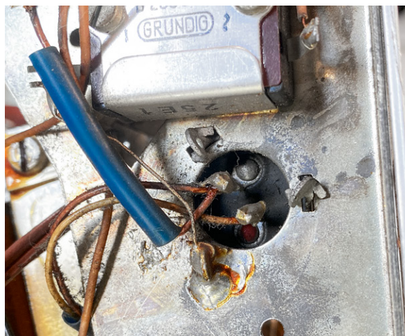
Bild 2: Ablöten der Anschlussdrähte und Verdrehen der Metalllaschen
