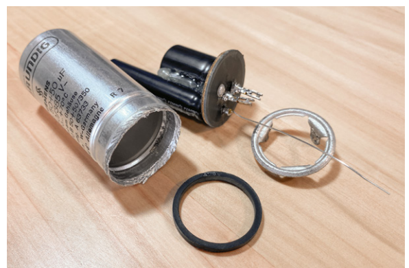
Bild 5: Mit neuen Kondensatoren bestückter Metallbecher
