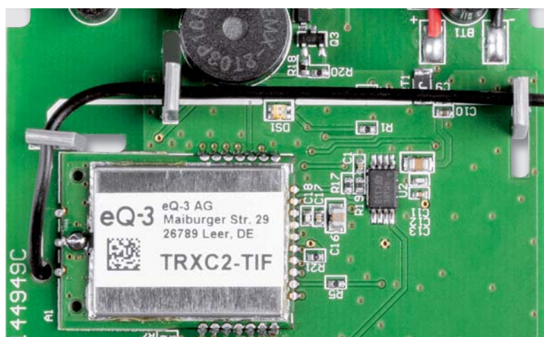
Bild 11: Die Verlegung der Antenne
