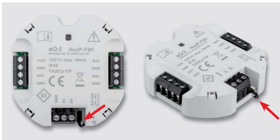
Bild 6: Das betriebsfertig montierte Gerät. Hier ist, durch den Pfeil markiert, noch einmal die neben der Schraubklemme herausgeführte Antenne zu sehen.
