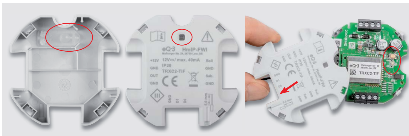
Bild 5: Das Gehäuseunterteil wird, wie hier gezeigt, auf den Gehäusedeckel gesteckt, wobei man die passende Lage über die Platinenform und die Lage von Lichtleiter, System-LED und Systemtaster findet. Die Antenne wird neben der unteren Schraubklemme herausgeführt, siehe Pfeilmarkierung.
