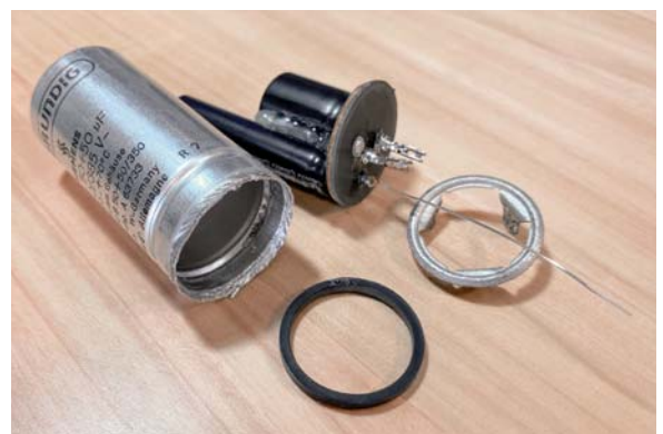
Bild 5: Mit neuen Kondensatoren bestückter Metallbecher
