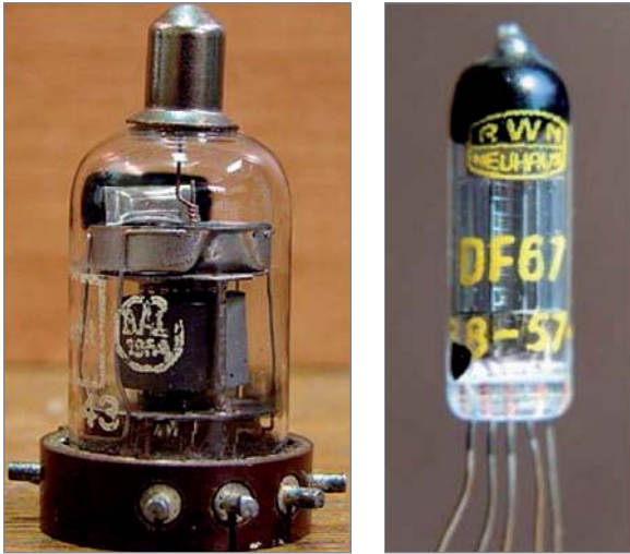
Bild 3: Elektronenröhren, die einst bei Hörgeräten zum Einsatz kamen. Linkes Bild: RV12 P2000, Einsatz im Siemens Phonophor-Super, 1948, Rechtes Bild: DF67, Einsatz im Blaupunkt Omniton-Gerät, 1950
