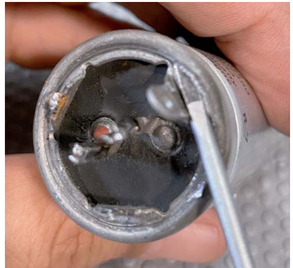
Bild 3: Anheben der Ummantlung vom Sockel
