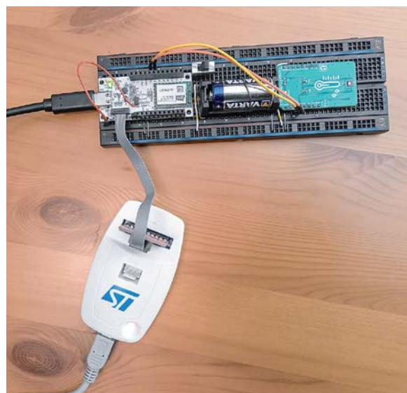
Bild 2: Prototypenaufbau mit Temperatursensor auf Grundlage der LoRIS-Base
