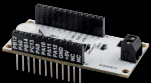
LoRIS Applikationsmodul Temperatur Luftfeuchte
