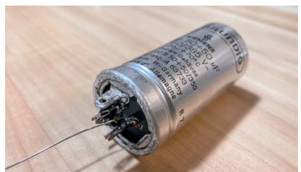
Bild 6: Das Ergebnis des Kondensatortauschs - optisch nahezu identisch mit dem Original
