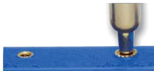
Bild 10: So funktioniert das thermische Einpressen des Gewindeeinsatzes. Er sollte so tief eingesetzt werden, dass er komplett im Material sitzt.
