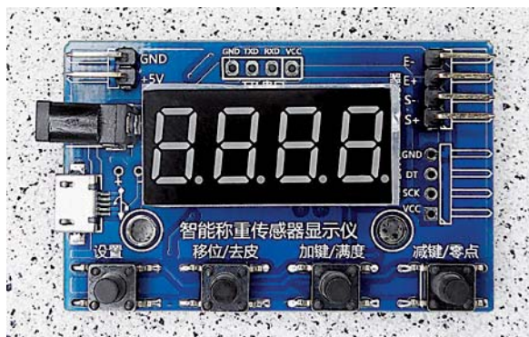
Bild 13: Mit solch einem Fertigmodul und einer Wägezelle lässt sich eine einfache Waage fast ohne Löten bauen.
