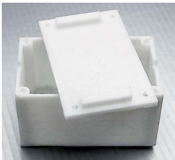
Bild 2: Konstruktion ohne Bohrungen – die Schraublöcher wurden nach dem Druck eingebracht.
