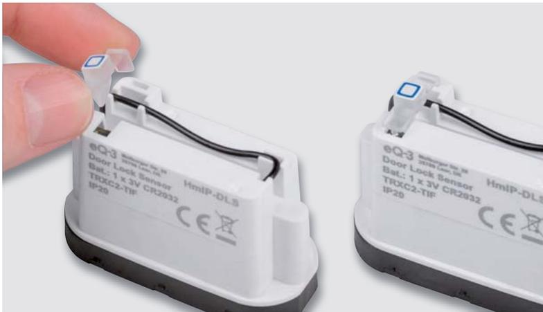
Nun wird der Lichtleiter (der gleichzeitig als Systemtaste dient) eingesetzt. Dieser wird bis zum Anschlag in die Aussparung im Gehäuseoberteil eingedrückt. Nach diesem Vorgang muss noch überprüft werden, ob die Funktion einwandfrei gegeben ist (Stichwort: „Klickgefühl“). Der Lichtleiter darf nicht reiben, kleben oder Ähnliches.
