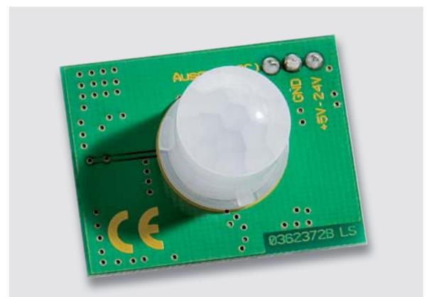
Bild 3: Signalquelle PIR-Sensor (hier der PIR13 aus dem ELVshop)
