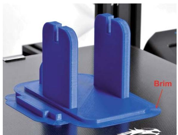
Bild 3: Fertiger Druck mit Brim zum Vermeiden des Warpings
