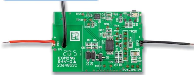
Die rote Versorgungsleitung wird mit der um 2 mm abisolierten Seite in die Durchkontaktierung MP1 geführt und anschließend von der Platinenunterseite her verlötet. Sinngemäß wird hier ebenfalls so mit dem schwarzen Leitungsstück und MP2 vorgegangen.
