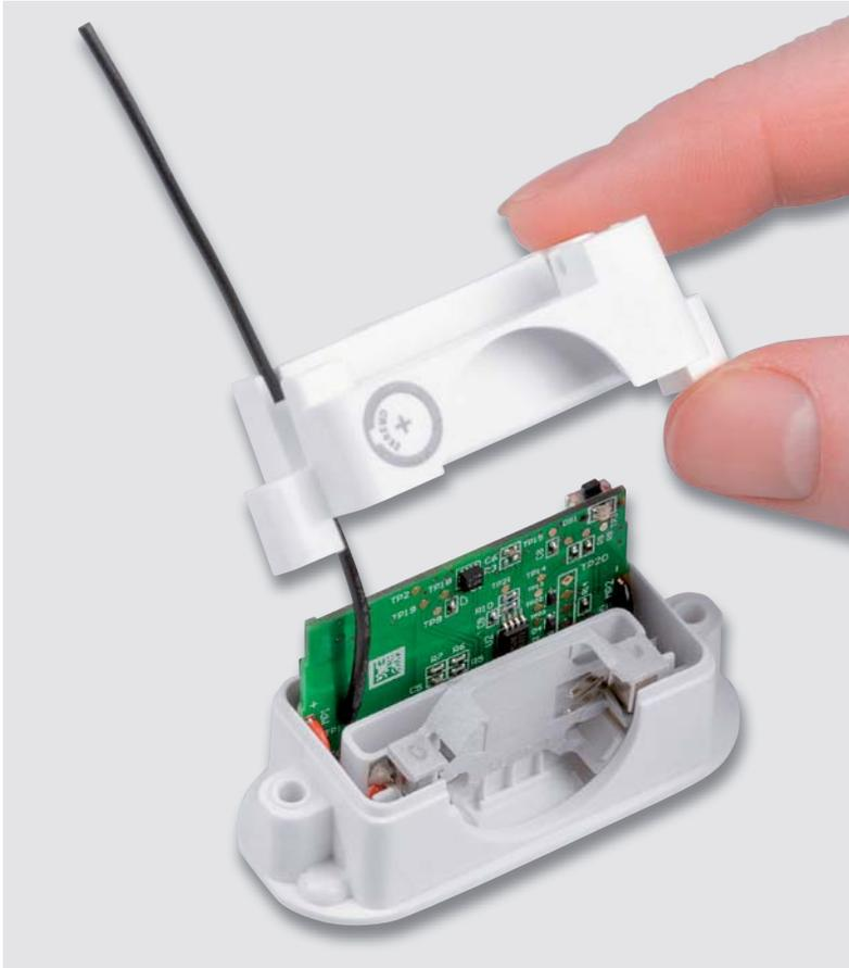
Nun kommt das Gehäuseoberteil zum Einsatz. Die Geräteantenne wird von innen durch die kleinste Öffnung im Gehäuseoberteil geführt. Am einfachsten gestaltet sich die Durchführung der Antenne, wenn das Gehäuseoberteil leicht schräg bei der weiteren Durchführung gehalten wird.
