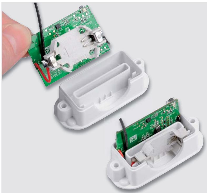
Im ersten Schritt des Gehäuseeinbaus wird die Platine mit dem angelöteten Batteriehalter in das Gehäuseunterteil eingesetzt. Dabei ist auf die richtige Ausrichtung des Batteriefachs und der Geräteantenne zu achten.
