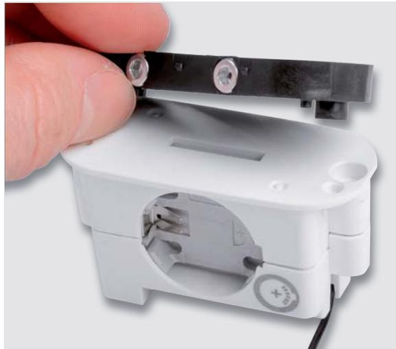
Nun wird das Gehäuse von der Schlüsselklemme aus mit den beiden selbstschneidenden Schrauben 2,5 x 14 mm verschraubt.
