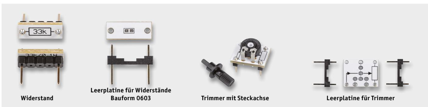
Bild 4: Widerstände und Trimmer als Prototypenadapter und Leerplatinen zum Bestücken
