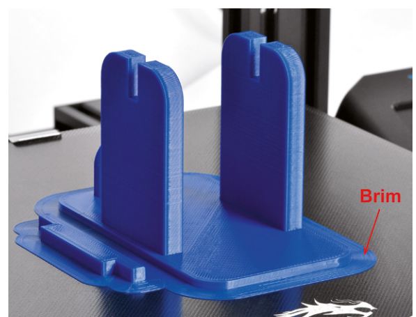
Bild 3: Fertiger Druck mit Brim zum Vermeiden des Warpings
