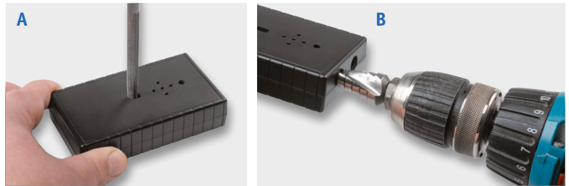
Bild 14: So werden die Bohrungen eingebracht.
