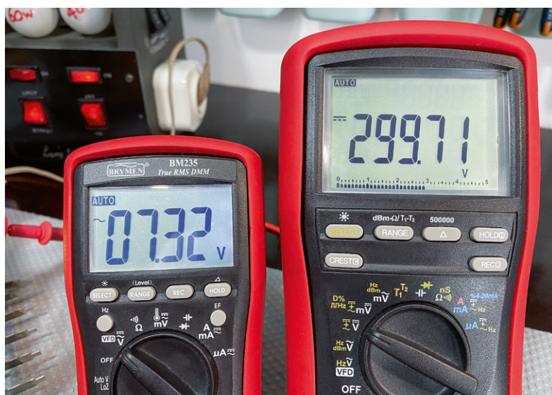
Bild 9: Die Heizspannung und Hauptversorgungsgleichspannung B+ sind vorhanden und scheinen in Ordnung zu sein.
