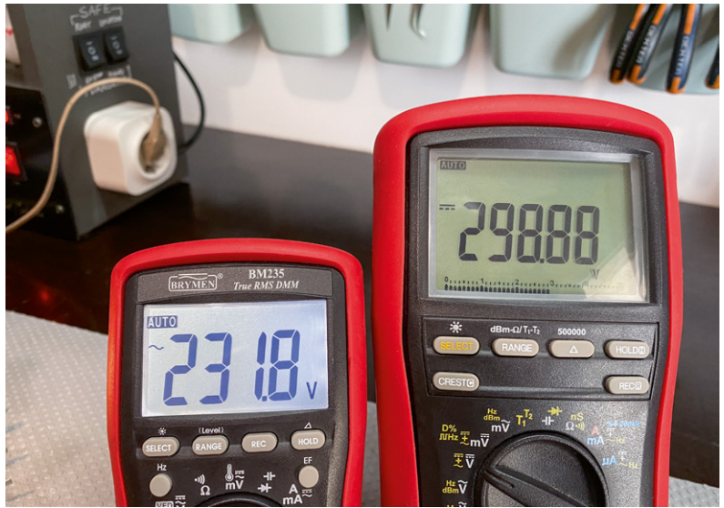
Bild 10: Ablesung der Wechselspannung des Selen-Gleichrichters und der Gleichspannung am Ausgang
