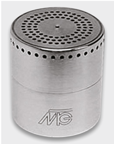
Bild 3: 1-Zoll-Messmikrofon-Kapsel, die auch zur Messung von Infraschall geeignet ist. Typ MK 103.1 (Microtech Gefell) Durchmesser: 23,8 mm/1"; Höhe: 26,5 mm; Frequenzbereich: 2 Hz–8 kHz; Freifeld-Übertragungsfaktor (Empfindlichkeit): 50 mV/Pa; Grenzschalldruck: 146 dB
