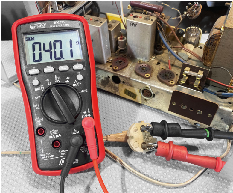
Bild 8: Messung des Widerstands des Netzprimärkreises
